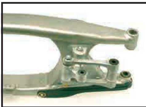
Neu entwickelt haben die Ingenieure die Hinterradschwinge aus Aluminium und das Umlenksystem für das Zentralfederbein.
