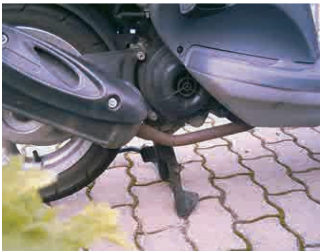
Blühender Rost auf dem Krümmer.
