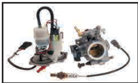
Die Viertakt-Modelle mit Straßenzulassung erhielten eine Einspritzanlage. Links ist die Benzinpumpe, die sich in dem Tank befindet, zu sehen. Rechts der Drosselklappenkörper mit einem Durchmesser von 42 Millimetern. Darunter die Lambda-Sonde.
