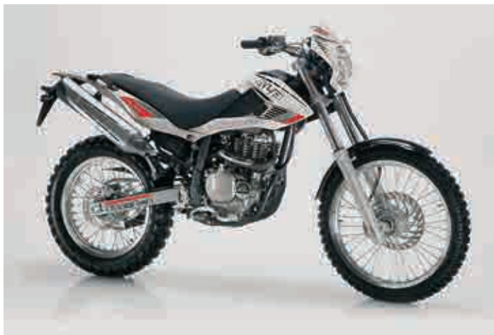
Mit U-Kat und Sekundärluftsysteem erfüllt nun auch die Alp 4.0 die Abgasnorm Euro 3.
