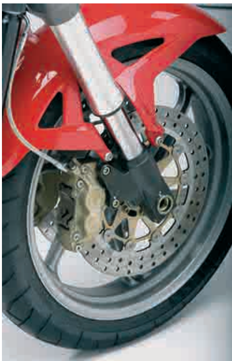
Upside-Down-Gabel, Vierkolben-Bremssattel und Stahlflexleitungen. Herz, was willst Du mehr?
