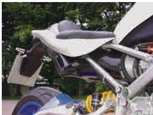
Links: Das Unterteil der Sitzbank aus Carbon ist gleichzeitig die Airbox für den 650er-Rotax-Motor. Die Schutzbleche hinten sind etwas knapp ausgefallen.
