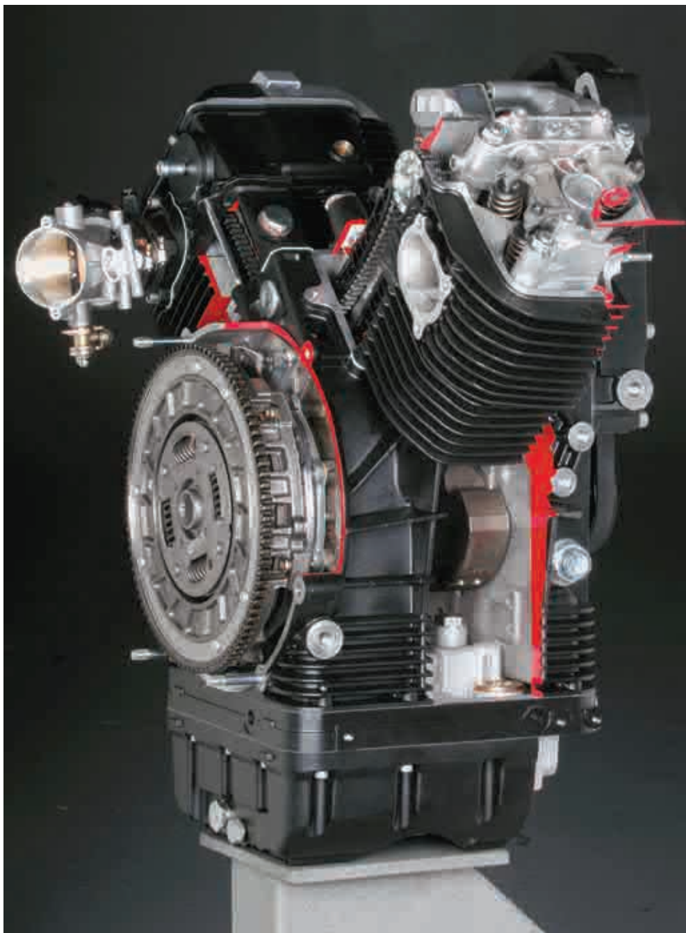
Der Vierventil-Motor wird bisher in den Modellen Griso 1200 8V und Stelvio 1200 4V verbaut. Zahnketten treiben die halbhohe Nockenwellen auf den Rückseiten der Zylinder an.
