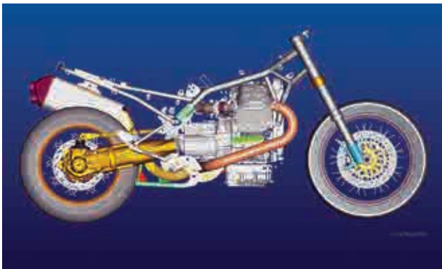
Auch bei der Stelvio verzichtet Moto Guzzi auf Rahmenunterzüge. Der Motor ist als tragendes Element in die Konstruktion integriert.
