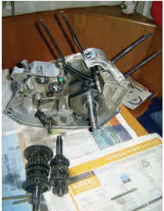
Blick in den Motor: Kurbelwelle und Nockenwelle stecken in der linken Gehäusehälfte. Davor liegt das Getriebe.
