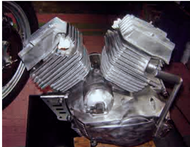
Der V-Motor nach dem Zusammenbau. Zwischen den Zylindern befindet sich die untenliegende Nockenwelle.
