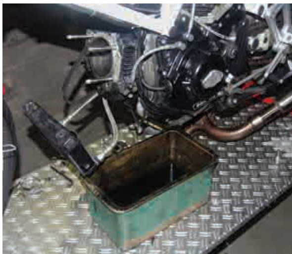
Eine Ölauffangwanne sollte immer unter dem Motor stehen.
