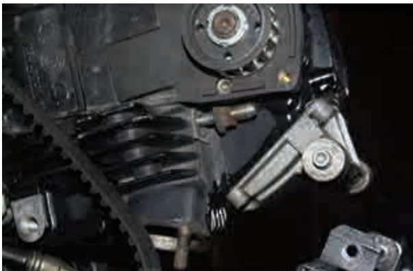
Beim Zerlegen zeigte sich, daß ein Stehbolzen gebrochen war - er ließ sich ein Stück herausziehen.
