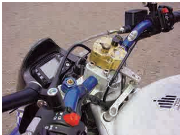
Ein Lenkungsdämpfer von Öhlins thront auf dem Lenker. Das kleine Cockpit wird teilweise von Bremsleitung und Kupplungszug verdeckt.
