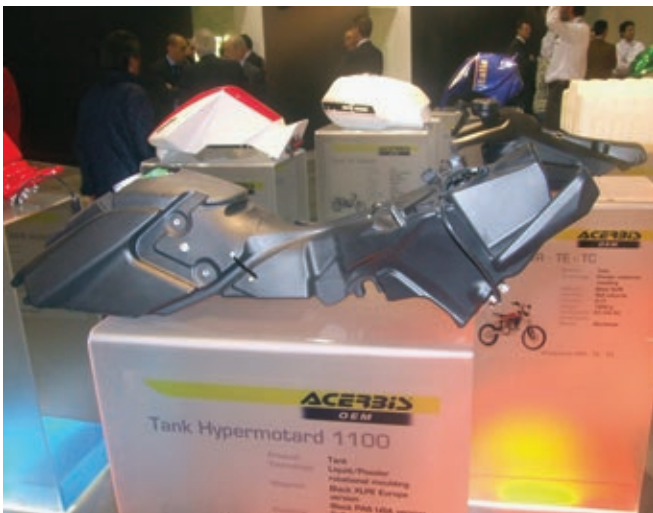
So sieht der Tank einer Ducati Hypermotard aus. Er wiegt 3,3 Kilogramm und hat ein Volumen von 12,4 Liter.
