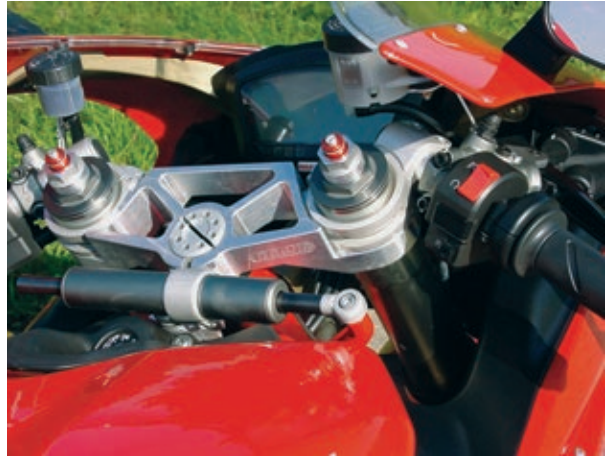
Eine stufenförmig gefräste Gabelbrücke macht es möglich, die originalen Stummel höher zu montieren.
