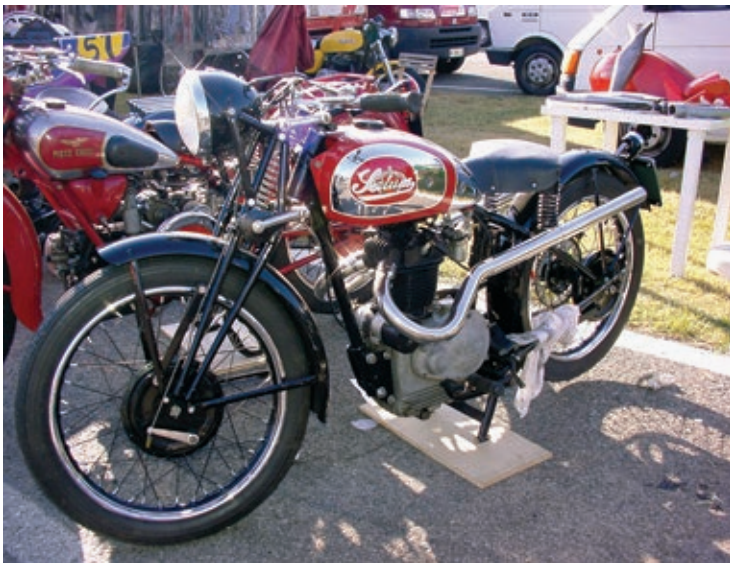
Für den Geländesport gab es hochgezogene Auspuffanlagen.
