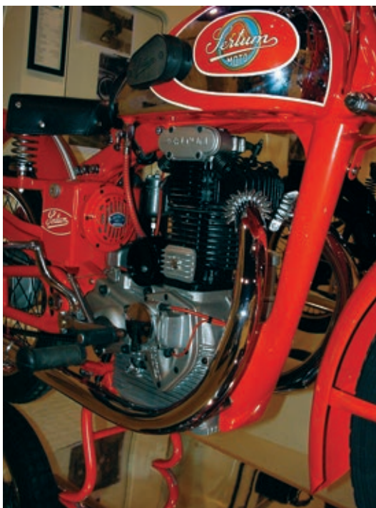
Sertum 250 VT-4 von 1947 mit hängenden Ventilen, teilweise offenem Ventiltrieb und Viergang-Fußschaltung.
