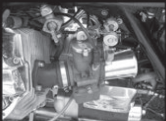
Dell'Orto Vergaser mit offenen Trichtern (Abstimmung mit Lambda-Sonde)
