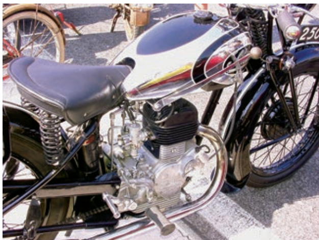
Ältere 250 VL mit Handschaltung und Starrahmen. Hinter dem silberfarbenen Deckel auf der rechten Zylinderseite verbergen sich die stehenden Ventile.
