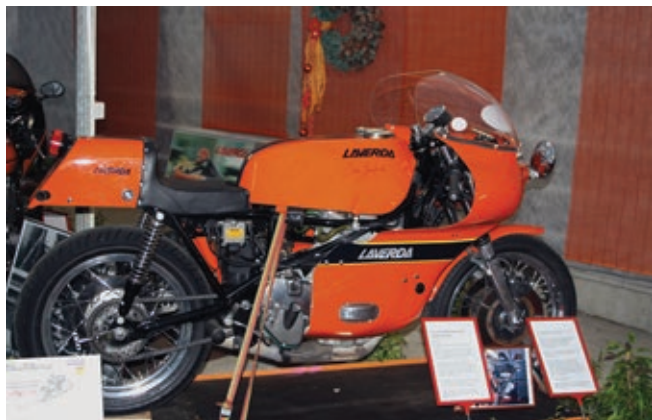
Eine von sechs gebauten Laverda-Rennmaschinen mit Gitterrohrrahmen.
