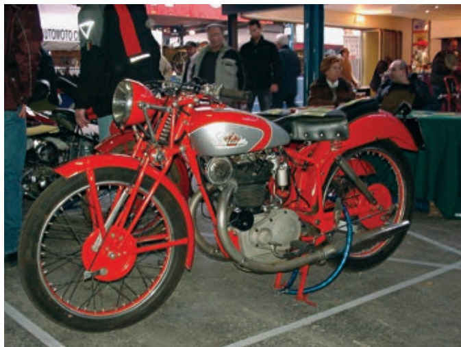
Eine etwas ungewöhnliche 250er mit recht moderner Hinterradfederung. Die meisten Sertums verfügten über Reibdämpfer und senkrecht unter dem Fahrersitz stehende Blattfedern.
