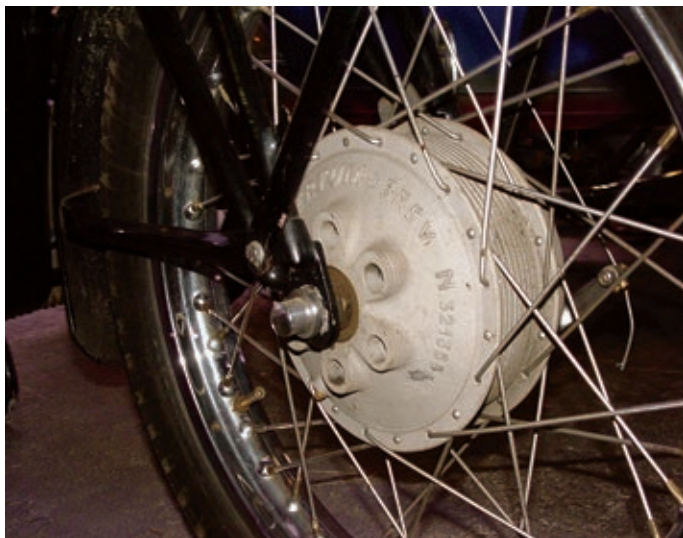
Alberti war einer der ersten italienischen Motorradhersteller, der seine Motorräder mit Vollnabentrommelbremsen ausstattete. Vorder- und Hinterrad waren mit gleichen Naben untereinander austauschbar.
