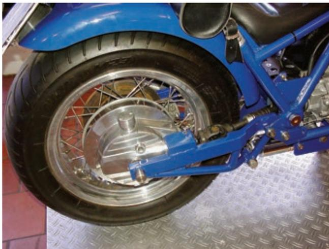
*Spezialschwinge der Firma Kindermann für besonders breite Reifen, wie sie in Choppern beliebt sind. Die Stoßdämpfer befinden sich waagrecht unter dem Getriebe.*
