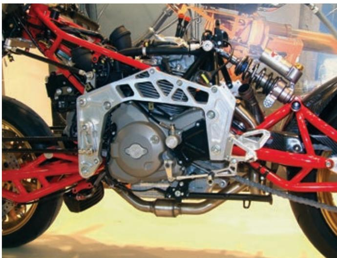
***Zwei gefräste Aluminiumplatten mit Durchbrüchen bilden den eigentlichen Rahmen.***
