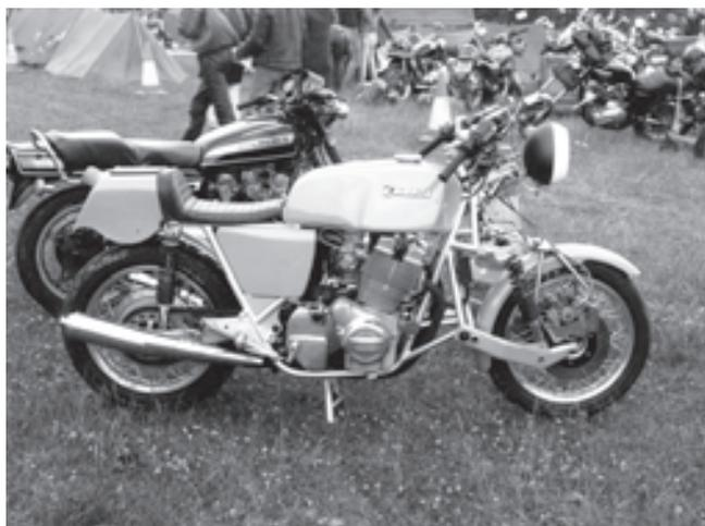
*Jack Difazio gilt als der Erfinder der Radnabenlenkung. Der britische Motorradhändler und Rennfahrer hat viele Serienmotorräder wie diese Laverda 1000 auf seine Radnabenlenkung umgebaut.*
