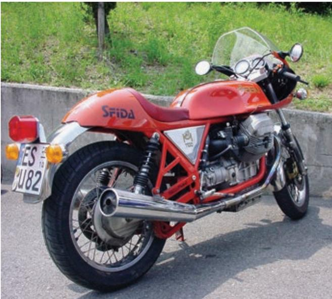
***In Kleinserie baute Arturo Magni Komplettfahrzeuge mit Guzziantrieb und Parallelogrammschwinge.***
