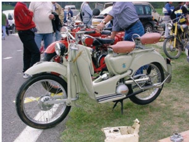
*Dieser Aermacchi-Roller verfügt ebenfalls über eine geschobene Langschwinge. Die Federung befindet sich gekapselt hinter dem Vorderradschutzblech. Auch sonst weist dieses Fahrzeug einige Besonderheiten auf, so dienen die Schalldämpfer gleichzeitig als Hinterradschwinge.*
