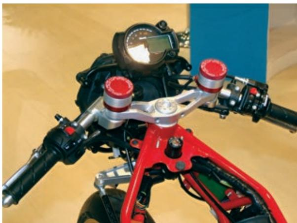
*Ein verhältnismäßig dünner Frontrahmen stützt den Lenkkopf. Die filigrane Gabelbrücke hält die beiden Lenkerstummel. Auf ihr sitzen ähnlich wie bei der Bimota DB1 die Ausgleichsbehälter für Kupplung und Vorderradbremse. Unter dem Lenkkopf befindet sich ein Hebel, welcher die Lenkbefehle über ein Gestänge weiterleitet.*
