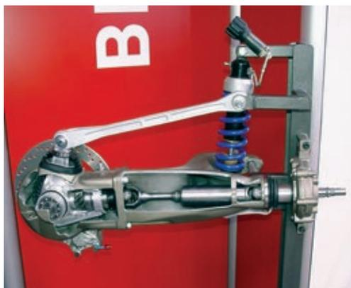
*Seit der Vorstellung der Griso hat Moto Guzzi mehrere Modelle mit dieser Einarmschwinge ausgestattet. Der Winkeltrieb ist drehbar im Endgehäuse gelagert. Die Kreuzgelenke arbeiten geschützt im Inneren der voluminösen Schwinge.*
