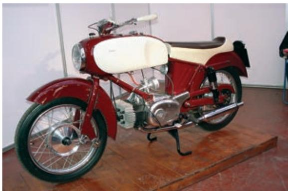
*Die Rumi links verfügt über eine geschobene Kurzschwinge. Federung und Dämpfung sind innerhalb der Gabel verborgen. Bei dieser Konstruktion ist der Federweg relativ begrenzt. Außerdem versteift sich bei Schwingengabeln beim Bremsen die Federung, wenn die Bremsankerplatte mit der Schwinge verbunden ist.*
