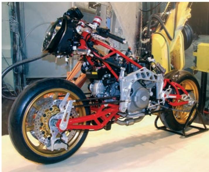
***Die fehlende Verbindung zwischen Lenkkopf und Vorderradachse ist gewöhnungsbedürftig.***
