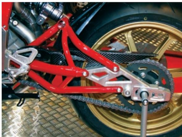
*Bei der Hinterradschwinge handelt es sich um eine Verbundkonstruktion aus Stahlrohren und gefrästen Aluminiumplatten. Bimota hat als einziger Hersteller so eine Konstruktion im Programm. Theoretisch kann man durch das Verwenden anderer Aluminiumplatten den Radstand verändern.*
