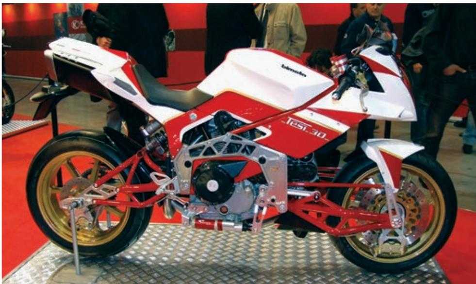
*Die aktuelle Version der Bimota Tesi mit Radnabenlenkung verfügt über Schwingen aus Stahlrohren.*
