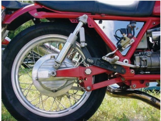
***Eine dritte Umbauvariante für Serienfahrwerke ist die Parallelogrammschwinge von Arturo Magni.***
