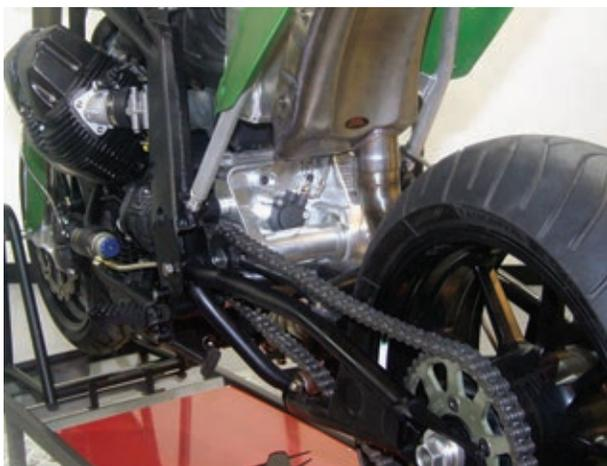
triebes, von dem sie ca. 75 Prozent der Bauteile übernehmen konnten, ein neues Getriebe mit Kettenantrieb entwickelt. Diese Konstruktion baut sogar noch kürzer als die originale Schaltbox und stellt so eine interessante Alternative da. So lassen sich ein paar Kilogramm einsparen.
