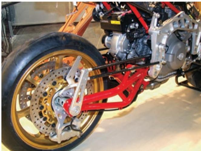
***Über die obere Stange stützt sich die Bremsanlage gegen die Rahmenplatte ab. Die untere Strebe verbindet den Lenkhebel an der Radnabe über mehrere Umlenkhebel mit der Stange, die zum Lenkkopf hoch führt.***
