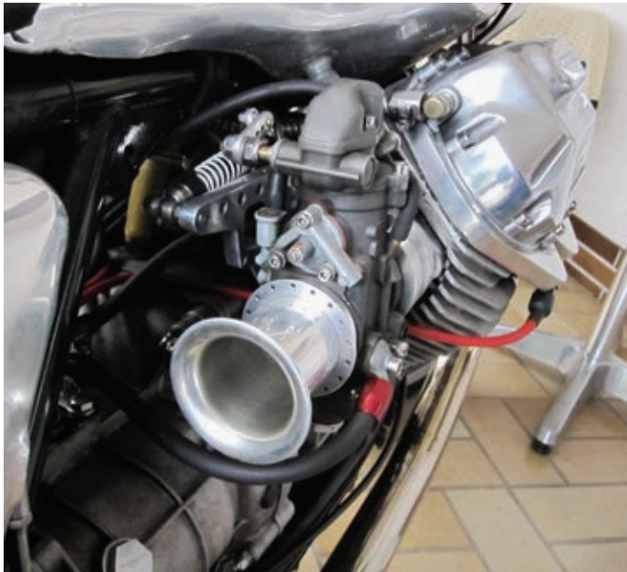
Die neue Vergaserbetätigung machte gerade Ansaugstutzen notwendig.
