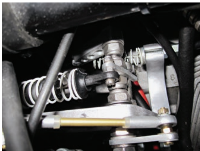
Blick von oben auf die Vergaserbetätigung. Von rechts führt der Bowdenzug zu dem Hebel oben. Dieser verdreht die Welle, an deren Enden sich die Hebel für die Betätigung der Vergaser befinden. Außerdem ist auf jeder Seite ein kleiner Stoßdämpfer mit der Welle verbunden.
