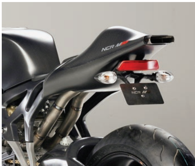
Der Auspuff für die stehenden Zylinder ist schön in das Heck integriert.
