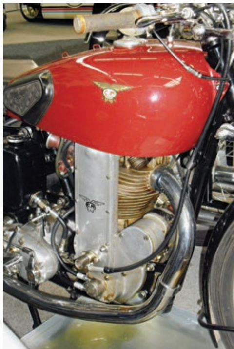
Die C.M.-Motorräder aus Bologna verfügten bereits früh über obenliegende Nockenwellen und andere technische Feinessen.
