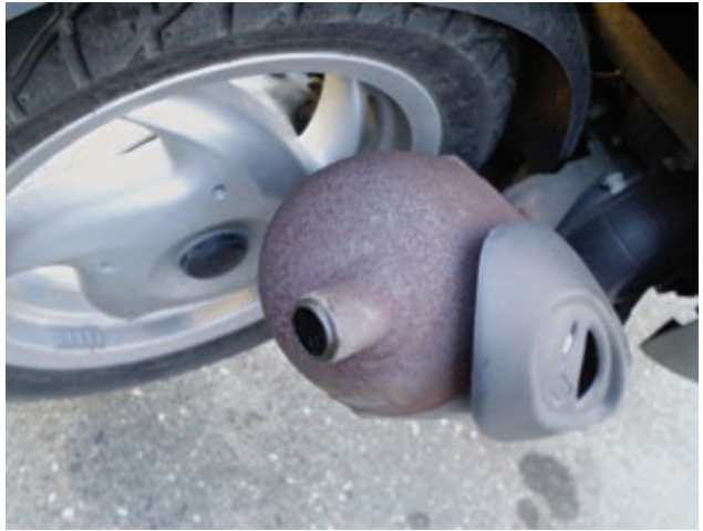
Bereits nach kurzer Zeit sah der Auspuff des Rollers verrostet aus.
