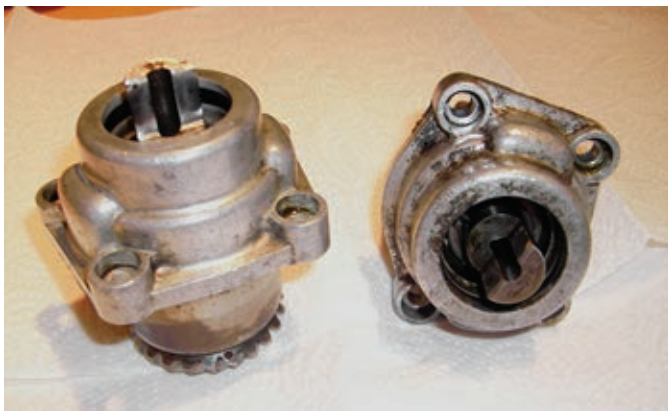
Die genial-einfache Verbindung der Königswelle mit zwei abgeflachten Zapfen begeistert Rolf im Brahm.
