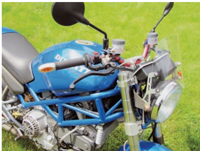
Kleines Windschild, radiale Handpumpen und die Kellermann-Blinker wurden nachgerüstet, um die CHR nochmals aufzuwerten.
