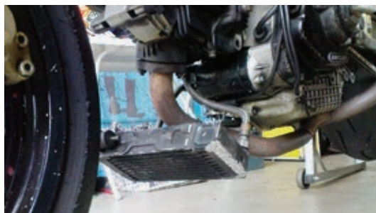
Glück gehabt - der lose runterhängende Ölkühler ist nur angeschliffen - ein Ölleck hätte böse enden können.
