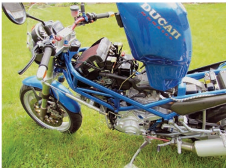
So schaut es unterm Tank aus - der Luftfilterdeckel wurde im Zuge der Tuningmaßnahmen aufgeschnitten, damit der Motor kraftvoll durchatmen kann.
