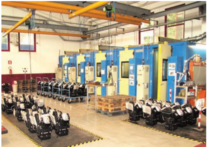
Fertige V2-Aggregate warten vor den Motorprüfständen auf ihre Bewährungsprobe.
