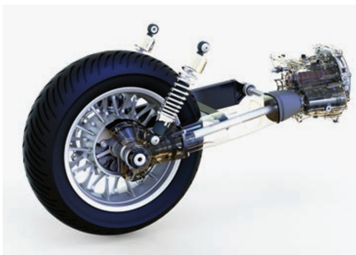
Der Aufbau des Antriebsstranges von rechts nach links: Einscheibenkupplung, Sechsgang-Getriebe, Kardanwelle mit verdecktem Kreuzgelenk und Winkeltrieb an der Hinterachse. Die Hinterradfederung übernehmen wie bei allen anderen Calis zwei normale Stoßdämpfer.
