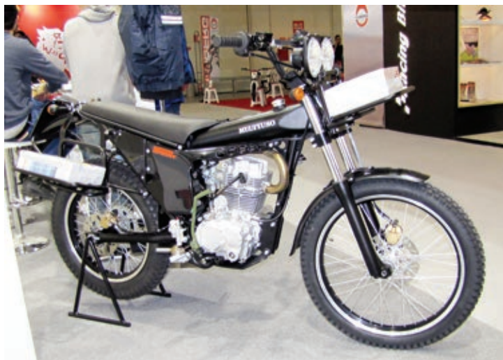
Bei der Borile Multiuso mit Doppelscheinwerfer befindet sich der Tank im oberen Rahmenrohr.
