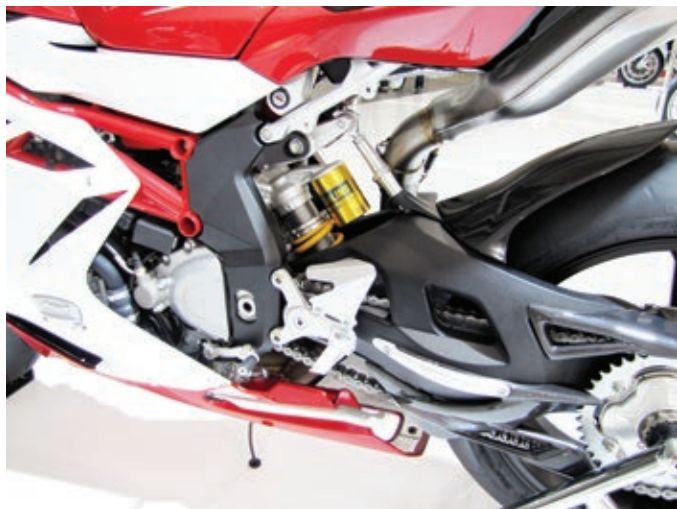
Bei der F4 RR ist die Fußrastenanlage verstellbar.
