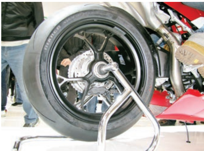
Schmiederäder im neuen Design helfen Gewicht sparen. Auch hinten verbaut MV Agusta einen Vierkolbenbremsattel.
