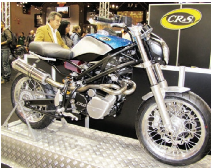
CR&S Vun mit halbhoher Auspuffanlage und fehlendem Kühler.
