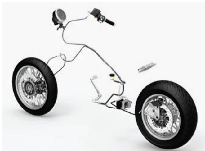
Der Aufbau des ABS-Systems und der Motorsteuerung.
