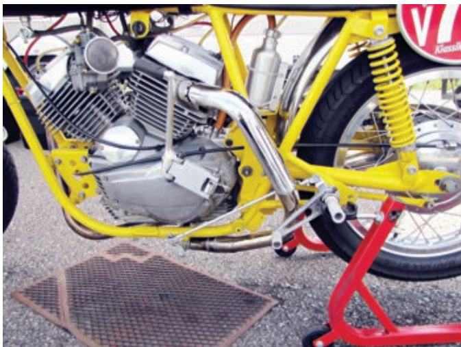
Umgebaut auf Linksschaltung und zurückverlegte Fußrastenanlage.
