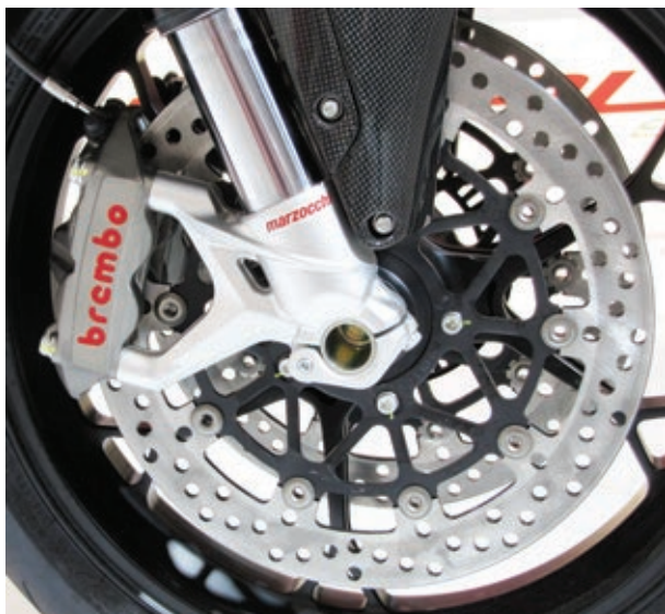
Die neue Marzocchi-Gabel verfügt über Schnellverschlüsse für eine einfache Raddemontage.
