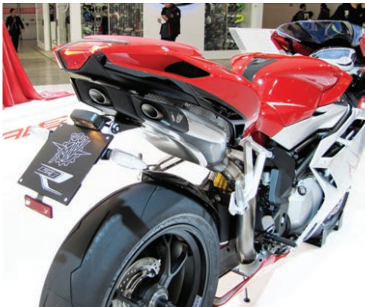
Die neue Auspuffanlage hat eckige Endkappen und runde Auslaßrohre.
