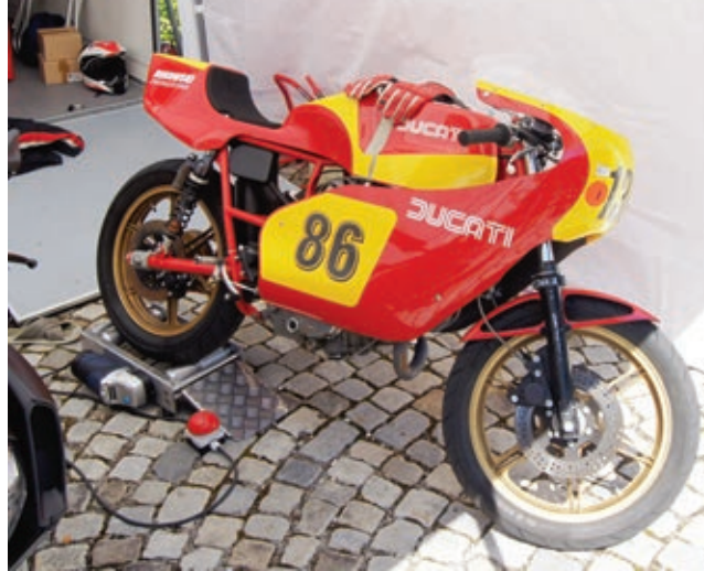
Ducati-Renner auf Pantah-Basis. Rollenstarter mit Winkelschleifern, auch Flex genannt, erfreuen sich in der Szene immer größerer Beliebtheit.
