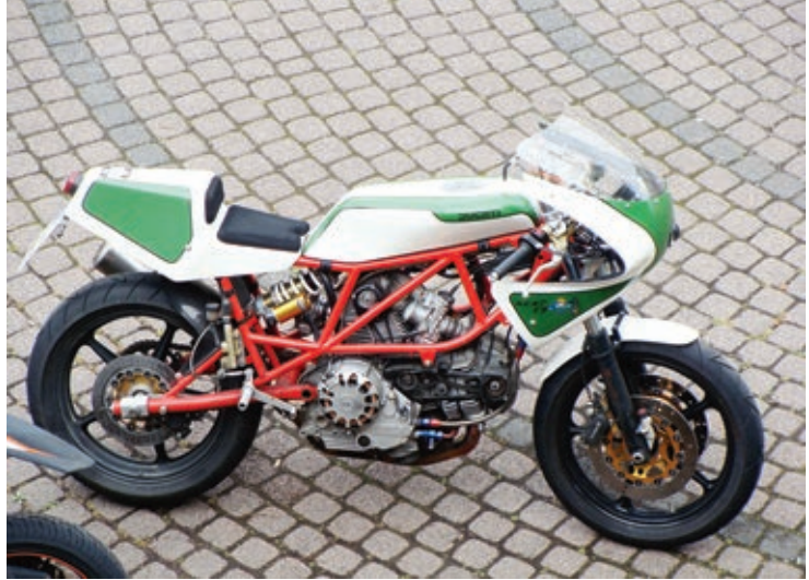
NCR-Pantah mit Spezialrahmen und Zentralfederbein.
