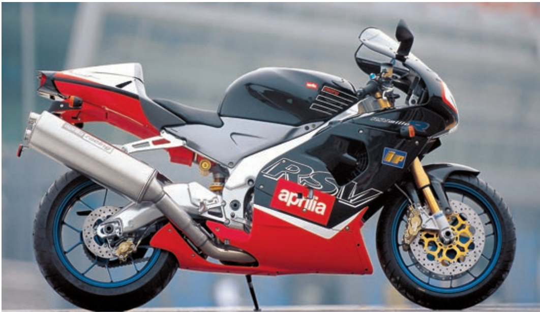
Schmiederäder und Öhlins-Dämpfer werten die RSV Mille R auf.
