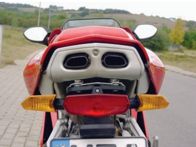
Die hintere Beleuchtungseinheit samt Kennzeichenhalter lässt sich schnell für Rennstreckenausflüge entfernen.
