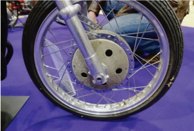
Die Bremse der Ducati 125 GP ist am Blühen und in der Hochschulterfelge befinden sich Holzspäne.
