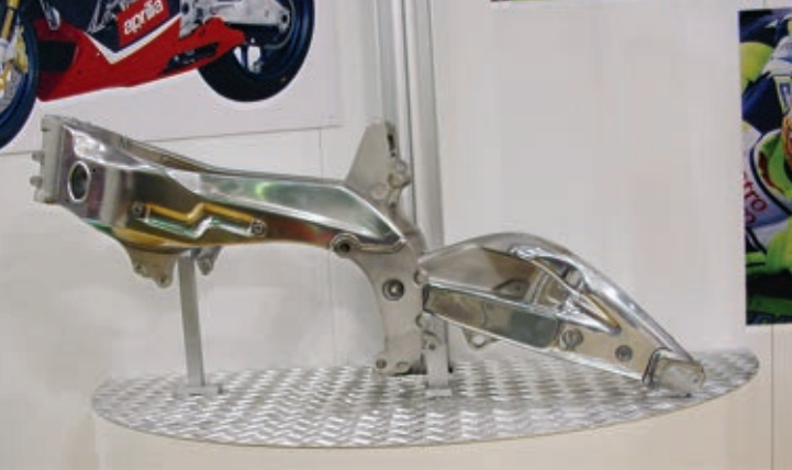
Rahmen und Hinterradschwinge stammen aus dem Superbike - hierin steckt die geballte Kompetenz der damaligen Rennabteilung.
