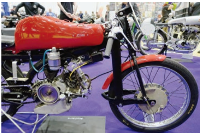
1947 entstand die erste Linto 75 Bialbero. Zwei obenliegende Nockenwellen werden über eine Kette angetrieben.
