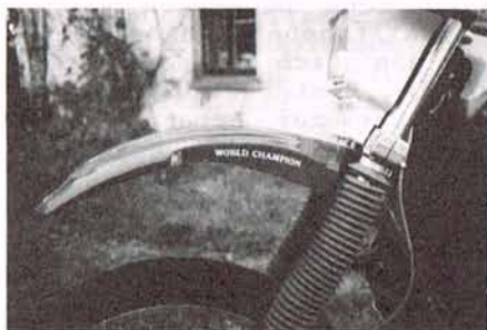
Das an der oberen Gabelbrücke montierte Schutzblech sorgt für leichte Fahrwerksunruhen im Höchstgeschwindigkeitsbereich
