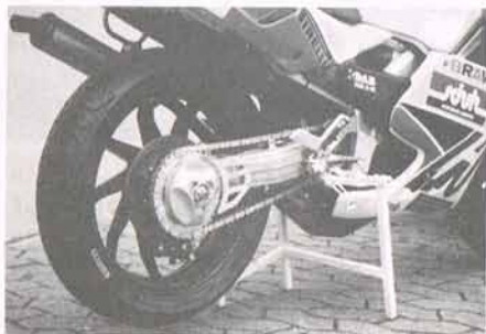
Die Einarmschwinge mit progressiver Hebelanlenkung hilft Gewicht sparen und erleichtert den Hinterradausbau
