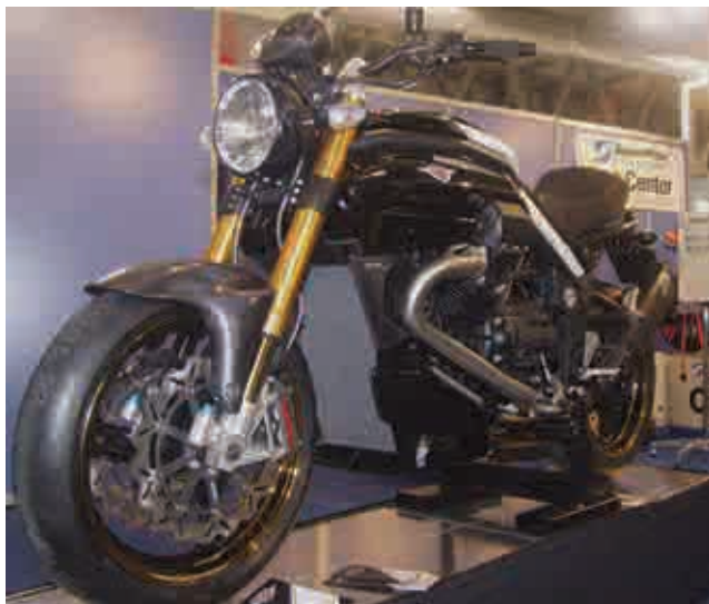
Milleper cento Big Bore BB1. Eine Moto Guzzi Griso mit Tuningkit, großem Wasserkühler und Öhlins-Gabel.
