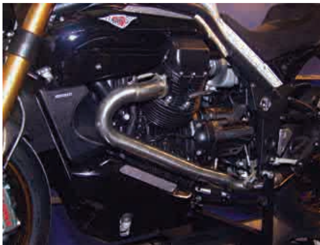
Milleper cento Big Bore BB1. Eine Moto Guzzi Griso mit Tuningkit, großem Wasserkühler und Öhlins-Gabel.
