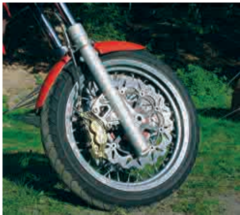
17-Zoll-Vorderrad mit standesgemäßer, moderner Bremsanlage.
