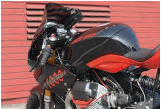
Kleine Filter ersetzen den Luftfilterkasten.
