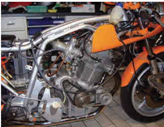
Ein Keilriemen treibt die Lichtmaschine vor dem Motor an. Hinter den Zylindern befindet sich der Anlasser.
