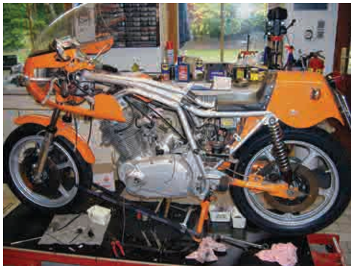
Der Rahmen der SFC unterscheidet sich von den anderen Laverdas.
