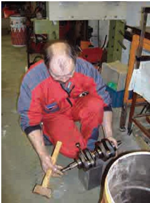
Kurbelwellerichten mit dem großen Kupferhammer.
