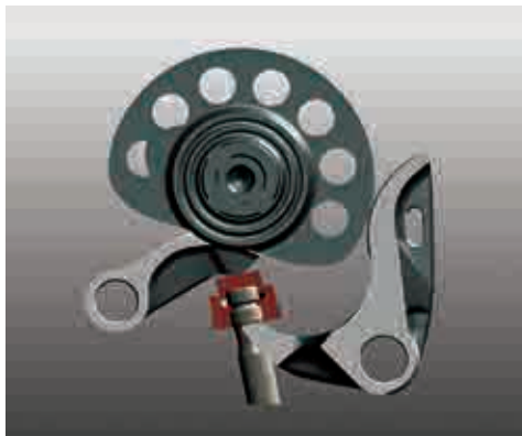
Die desmodromische Ventilsteuerung. Oben die Nockenwelle mit Erleichterungsbohrungen. Links unten der kleine Öffnerhebel und rechts der fast rechtwinkelige Schließerhebel. Auf dem Ventil sitzen Einstellkappchen und Einstellhülse.
