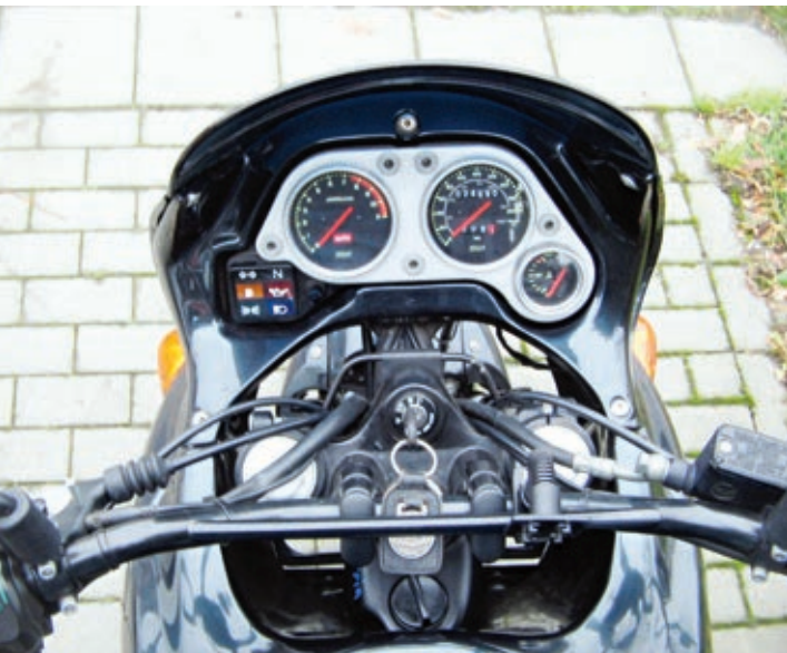
Übersichtliches Cockpit. Vor dem Tank befindet sich der Ölmeßstab.
