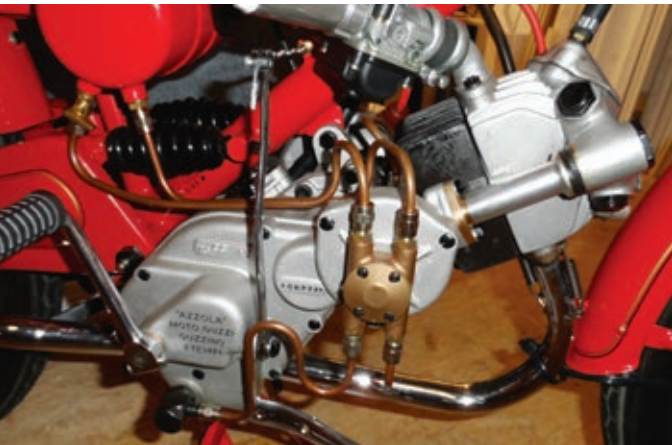
Der Umbausatz von Azzola umfaßte einen rechten Seitendeckel mit Ölpumpe und Nockenwelle, dazu Kolben und den Zylinderkopf mit komplettem Ventiltrieb per Stößelstangen und Kipphebeln.
