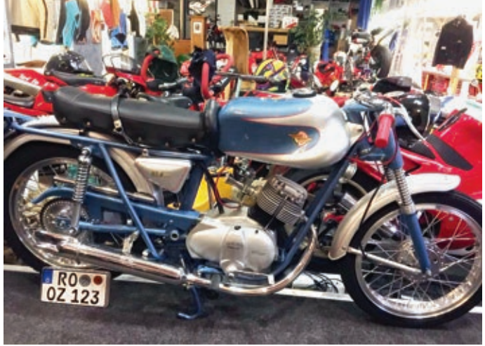
Ende der fünfziger Jahre baute Ducati diese 85 Sport mit Stößelstangenmotor und 5,5 PS.
