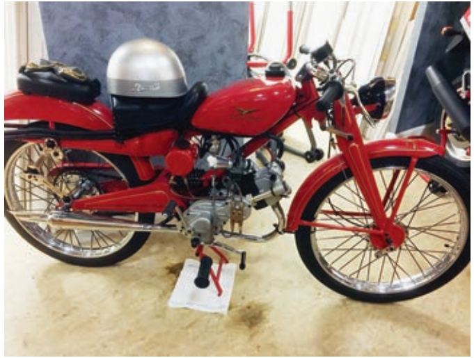
Original hat die Motoleggera 65 einen Zweitaktmotor. Edgido Azzola entwickelte einen Umbausatz zum Viertakter mit 73 Kubikzentimetern.
