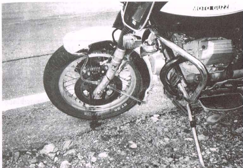
Kapitaler Schaden - Tauchrohr gebrochen, Schutzblech deformiert, Stück aus rechter Bremsscheibe herausgebrochen
