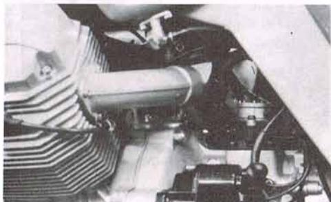
Die Ansaugbrücke und die, auf dem Getriebe sitzende, Benzinpumpe
