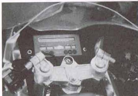
Das digitale Cockpit. Der obere Balken zeigt die Drehzahl. Die fünf Anzeigen in der unteren Reihe sind für Wasser, km/h, Kilometerzähler, Etappenzähler und Benzin.
