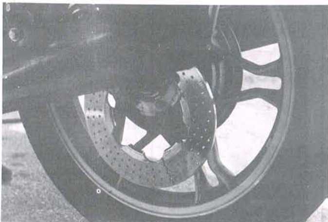
Völlig "frei schwimmend" gelagerte Bremsscheibe, leider nicht ganz ungefährlich
