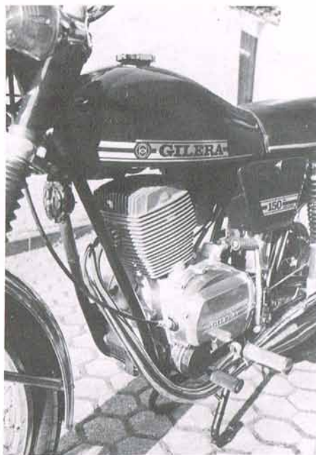
Das Herz der Strada mit außenliegendem Ölfilter. Darüber sitzt der Nockenwellenantrieb.
