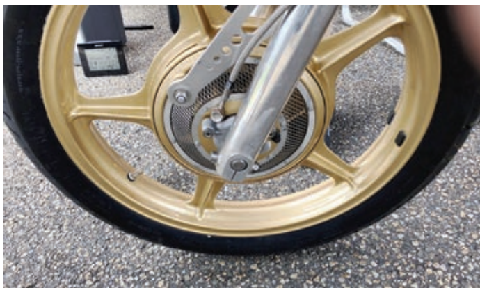
Hydraulische Konusbremse - ein interessanter Ansatz, der sich aber nicht durchsetzen konnte.
