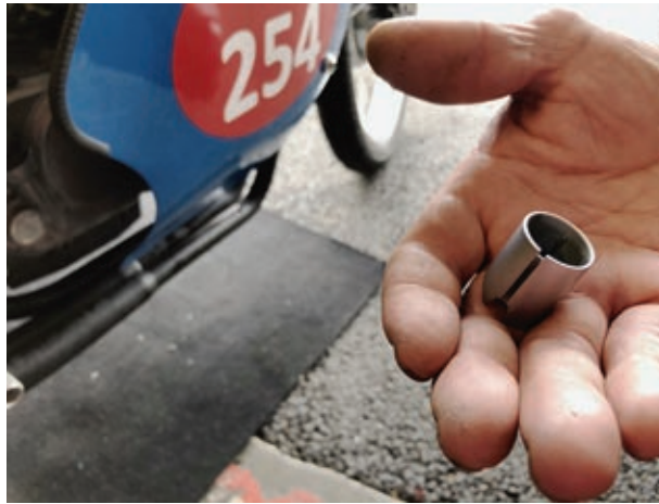
Gasschieber einer Benelli 250 Quattro - nicht größer als ein Fingerhut.
