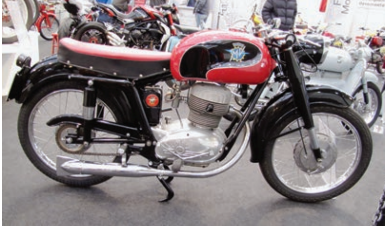
Eine 175 CSTL mit Fischschwanzauspuff und einem Vorderradkotflügel, welcher am oberen Gabelteil montiert ist, also nicht zu den ungefederten Massen gehört. Im Gegensatz zur CS und CSS besitzt die Turismo Lusso einen Luftfilter.
