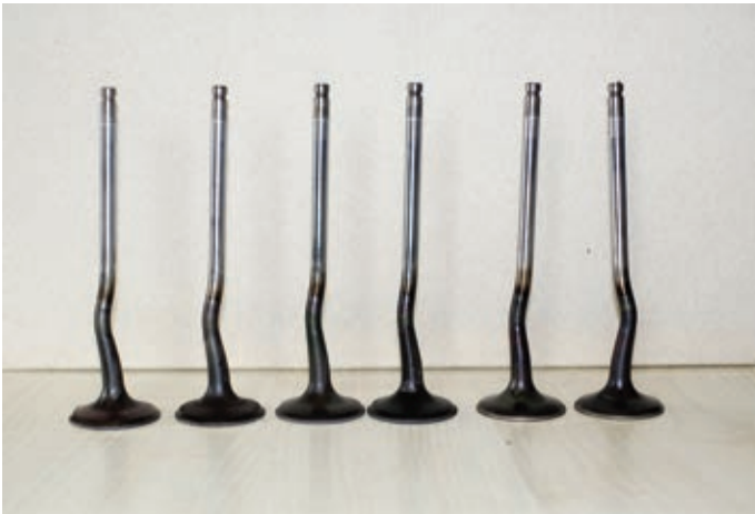
Die Auslassventile sind alle im unteren Bereich gestaucht und verbogen - Kernschrott. Das hat dazu geführt, dass auch die Ventilführungen im Kopf beschädigt sind.
