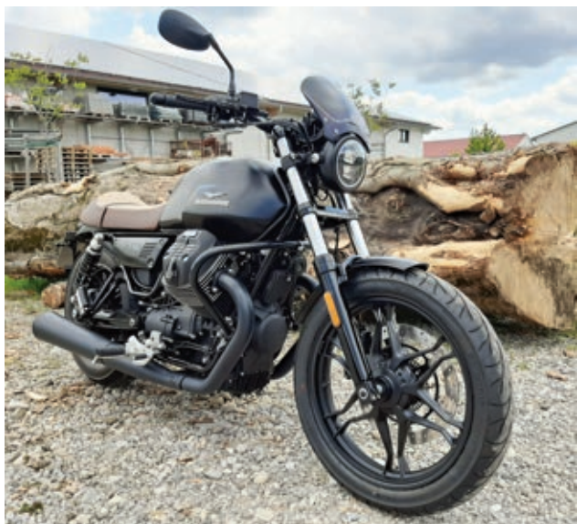
Die Front der V9 Bobber wurde komplett ausgetauscht gegen Bauteile von anderen V7-Modellen aus dem Hause Moto Guzzi.
