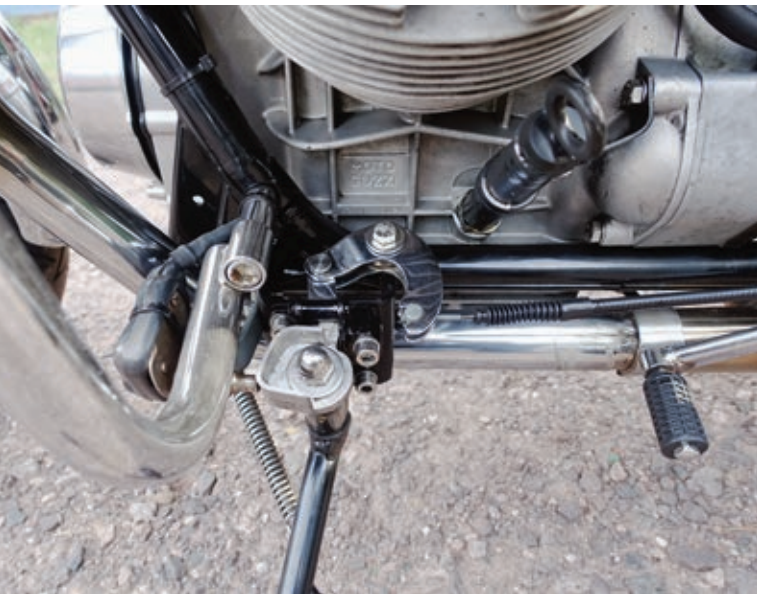
Vom Seitenständer aus führt ein Bowdenzug zur hinteren Bremsanlage.
