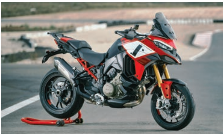
Einarmschwinge und 17-Zoll-Räder für Super-sportbereifung gehören zu den Merkmalen der Multistrada V4 Pikes Peak.
