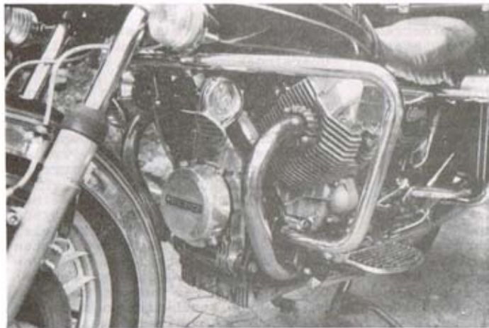
Der Limadeckel und das Steuergehäuse sind poliert. Aus VA-Blech wurden 90° Hupenhalter angefertigt.
