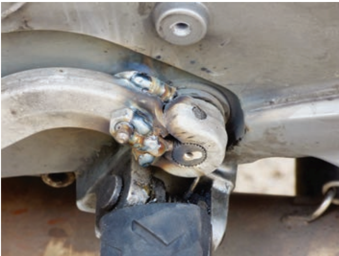
Die kreative Reparatur des Schalthebels hat 5.000 Kilometer gehalten.
