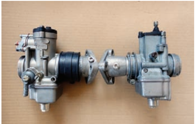
36er rund (links) und 30er eckig (rechts) im direkten Vergleich. Beim größeren Vergaser sitzt links oben die Beschleunigerpumpe. Außerdem verringert hier ein Gummi Vibrationen und Wärmeübertragung.
