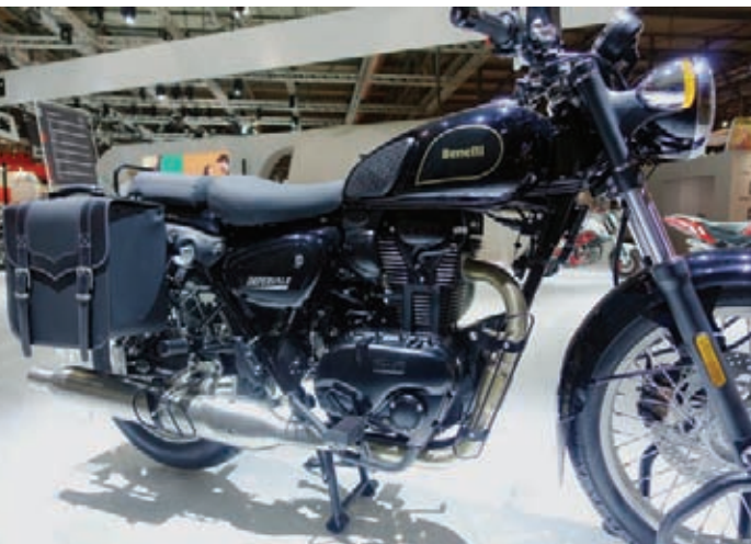
Imperiale 2.0 (2018): Schwarzer Motor mit überfrästen Kühlrippen. Dazu Schutzgitter an der Auspuffanlage.
