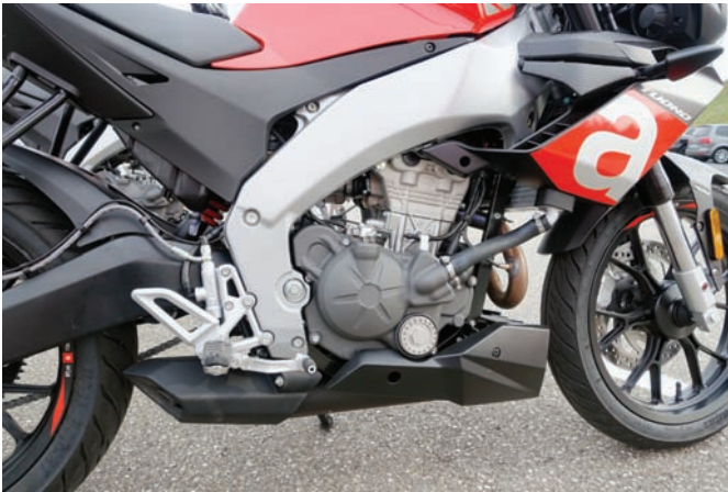
Neuer Viertaktmotor und Schalldämpfer unter dem Motor.
