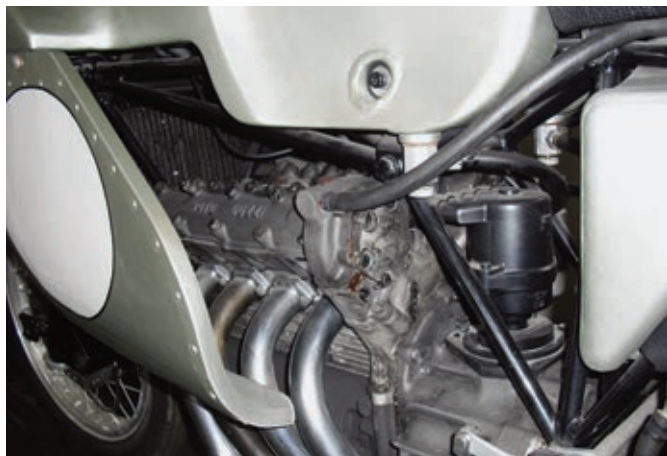
Auf dem Getriebe befindet sich die senkrecht stehende Magnetzündung.
