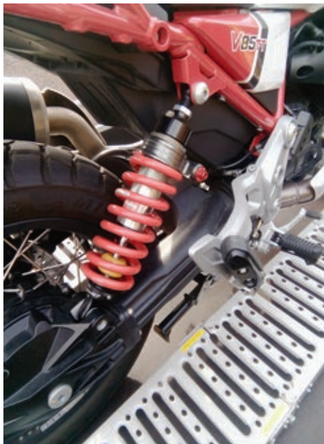
Bitubo-Federbein mit Höhenverstellung.
