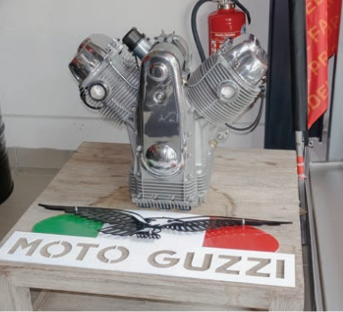
Links: Ein Moto Guzzi V7-Motor mit oben auf dem Motorgehäuse positionierter Lichtmaschine.
