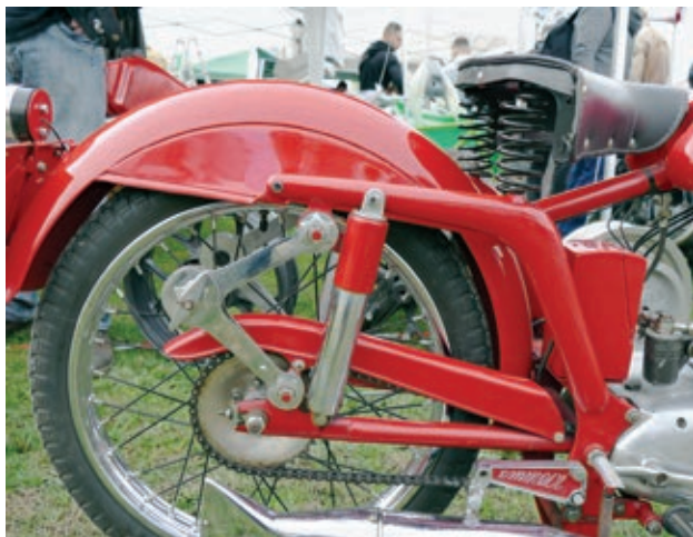
Das neue Heck mit Pressblechstahlteilen, Teleskopfederbeinen und Reibdämpfern.
