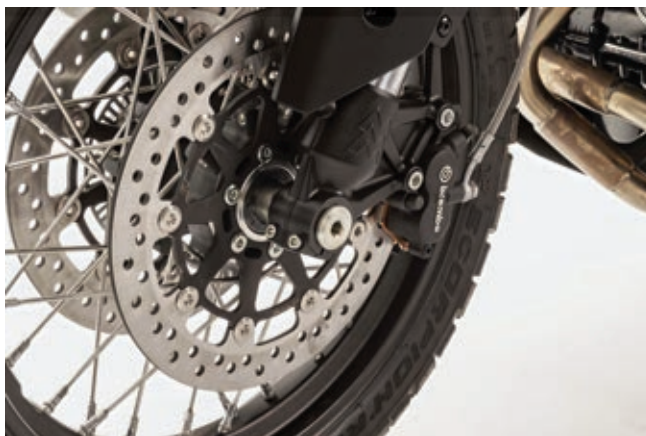
Brembo-Bremsanlage und eine Upside-Down-Gabel von Marzocchi.
