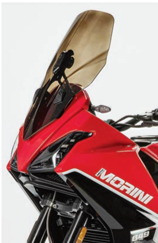
Höhenverstellbares Windschild und LED-Beleuchtung.
