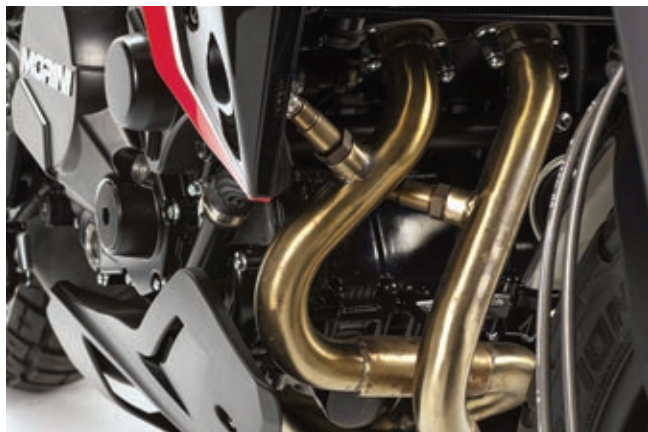
Edelstahlauspuffanlage mit Lambdasonden und Katalysatoren dicht am Zylinderkopf.
