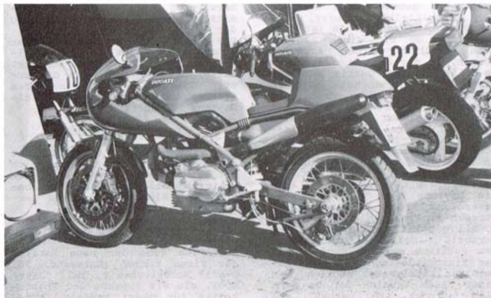
Diese in Deutschland zugelassene Ducati stand im Fahrerlager. Das Fahrwerk stammt aus England. Der Sitzbankhocker und die Verkleidung dienen als Ansaugeräuschkämpfer.
