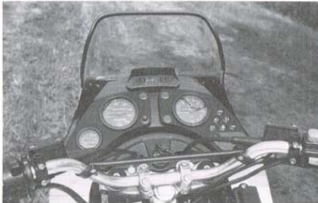
Das Cockpit mit Tacho, Drehzahlmesser, Öltemperaturanzeige und Digitaluhr. Die Kontrollleuchten sind kaum zu erkennen.
