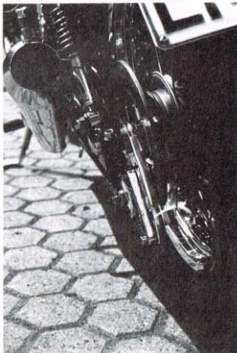
Rechts und links von der neuen Ankerplatte sorgen Hülsen für die seitliche Abstützung.
