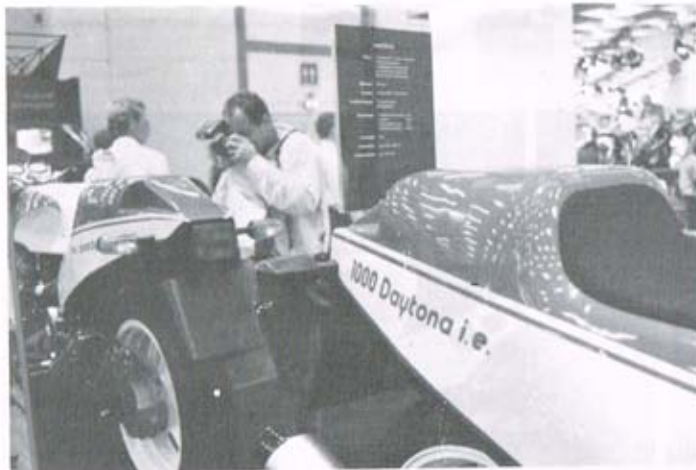
Die Daytona erhielt neben anderen Änderungen ein neues Heck. Die Lufteinlaßöffnung ist nicht mehr oben auf dem Bürzel, sondern zwei Schlitze weisen nach hinten.
