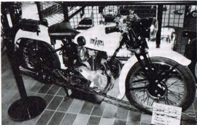
Links: Bianchi ES 250 von 1937. 10 PS bei 4800 U/min.
