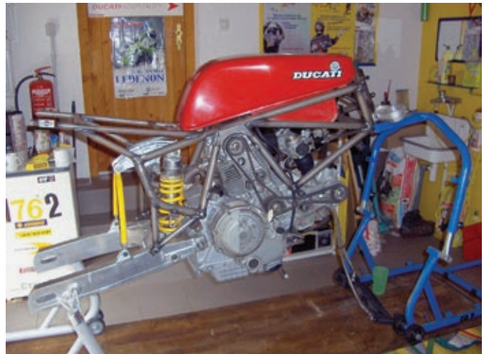
In der Aufbauphase. Die Montage der Schwinge verlangte ein paar Änderungen.
