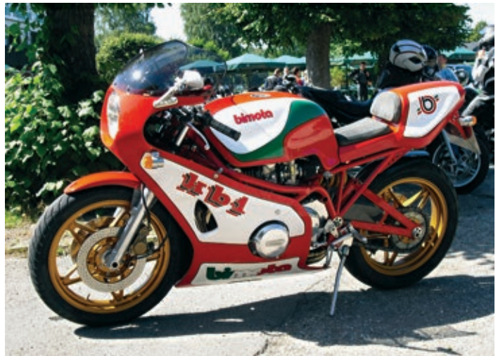
Nicht ganz original aber sehr schön. Eine Bimota KB1 mit dem Motor der Kawasaki Z 1000.
