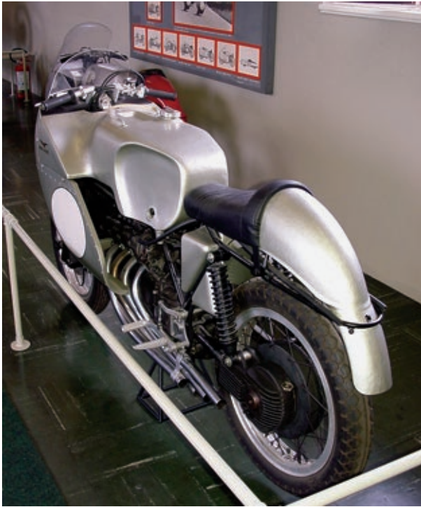
Mit der Quattro Cilindri 500 ging Moto Guzzi völlig neue Wege. Längsliegende Kurbelwelle und Kardan zeichnen die Maschine aus.
