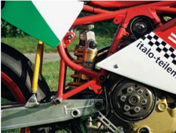
Jetzt passen auch die Schwinge und das Federbein aus der 916.
