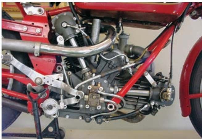
Aus dem erfolgreichen 250er-Einzylinder-Motor entstand der Weitwinkel-Zweizylinder-Motor der Bicilindrica.
