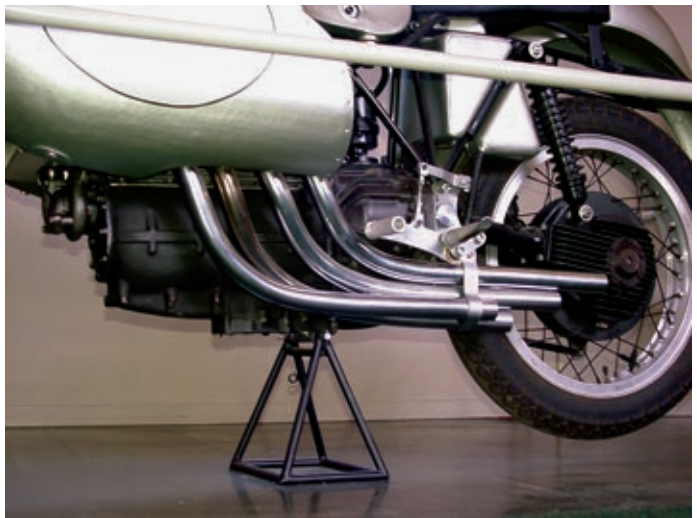
Die vier Krümmers sind exakt gleich lang. Vor dem Motor kann man die Wasserpumpe erkennen. Zur besseren Kühlung ist der Endantrieb großflächig verrippt.
