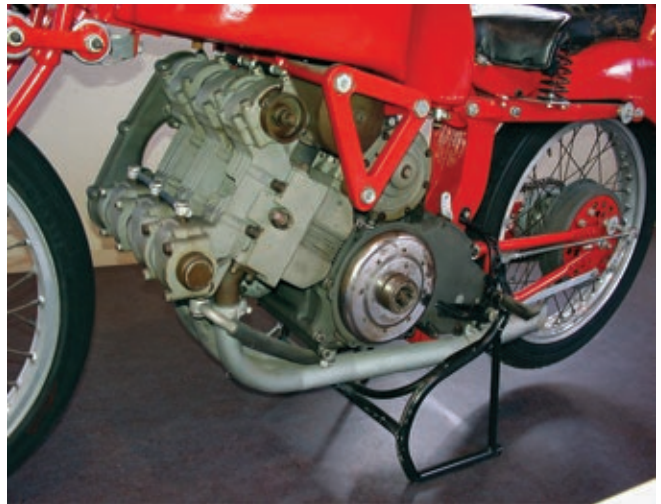
Der Dreizylinder-Motor verfügt über einen gekapselten Ventiltrieb mit zwei obenliegenden Nockenwellen. Der Kompressor ist oben auf dem Motorgehäuse montiert. Ein paar Teile des Motorrades fehlen leider.
