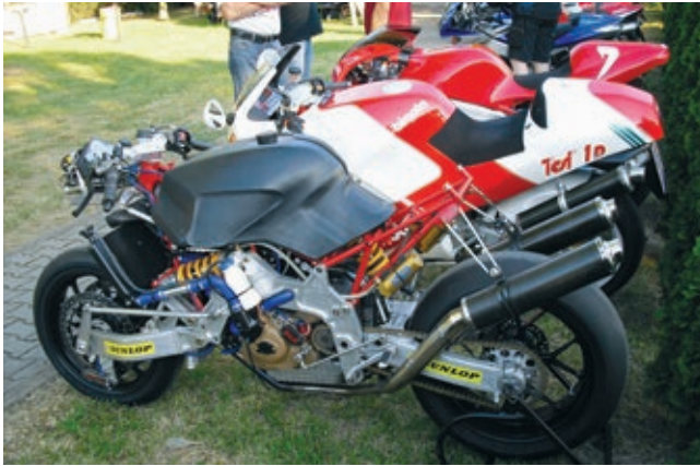
Immer wieder interessant: Eine Bimota Tesi mit Radnabenlenkung.
