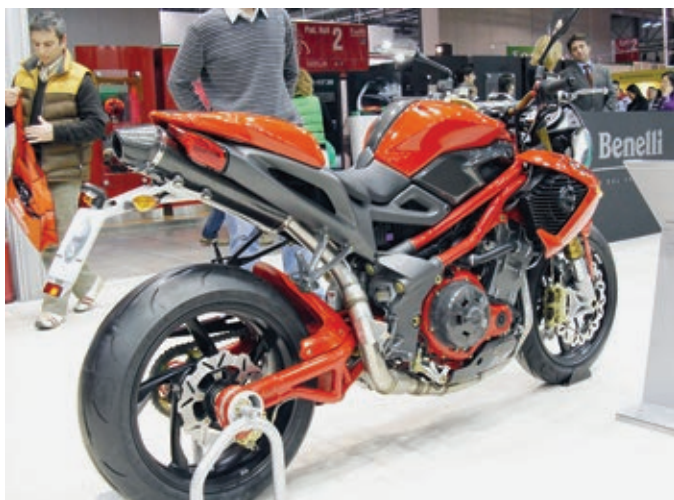
Mit dem Motor aus der Tornado 1130 und Trockenkupplung sowie anderem Auspuff und viel Carbon präsentiert sich die TNT R 160.
