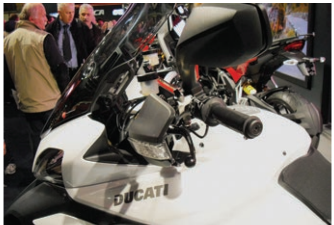
Um das Windschild zu verstellen, muß man zwei Flügelschrauben lösen. Die Blinker befinden sich in den Handschützern, die keine äußere Verbindung zum Lenker haben.
