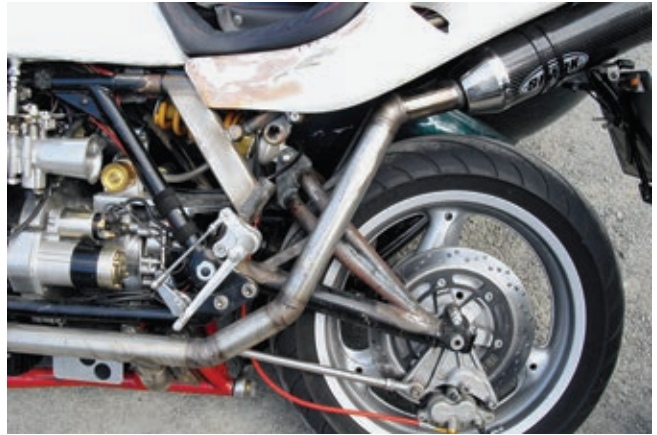
Schwenkergespann im Rohbau. Hier wird anscheinend gerade auf Zentralfederung und eine neue Auspuffanlage Marke Eigenbau umgerüstet.
