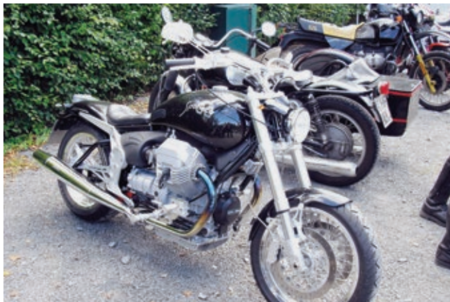
Die schweizer Firma GG bietet seit Ende der neunziger Jahre dieses Motorrad namens Spartaco auf Guzzibasis an. Viele schöne Frästeile und einige interessante Detaillösungen zeichnen diese Maschine aus.
