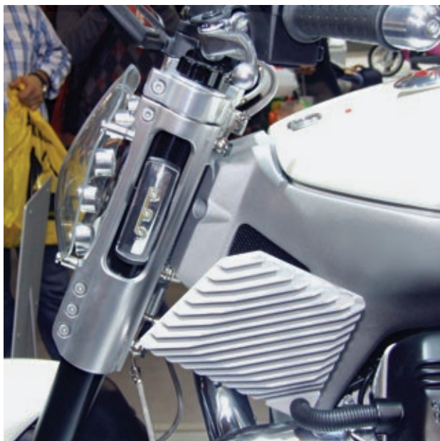
Dieser Kühlkörper soll heiße Luft von dem Zylinder ableiten. Die untere Gabelbrücke reicht bis zur oberen und verfügt über Hydraulikkanäle.
