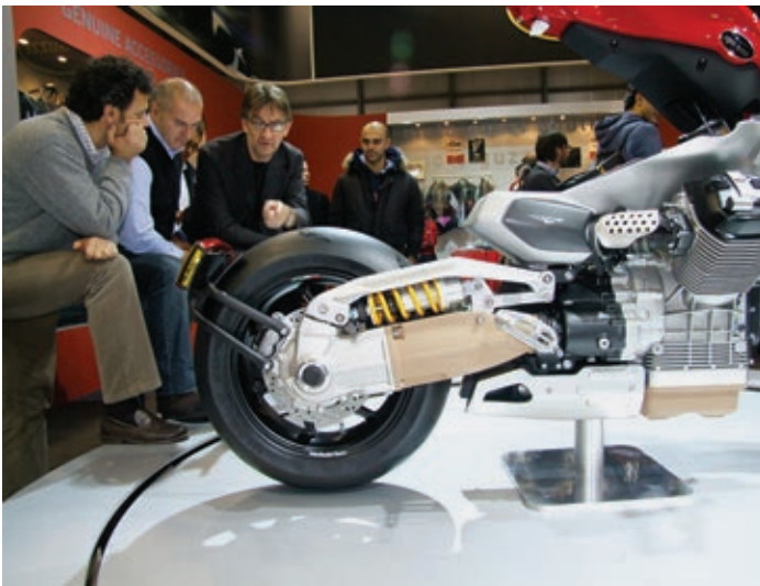
Pierre Terblanche (mit Brille) erklärt seinen Entwurf. Aufseherregend ist die auf der Schwinge montierte Hinterradfederung.
