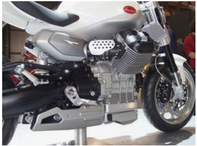
Der verkleidete Schalldämpfer befindet sich unter dem Getriebe. Fußrasten für Fahrer und Beifahrer sind kreisförmig verstellbar.
