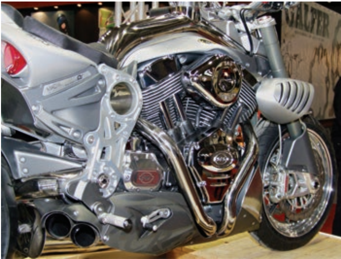
Der Auspufftopf sitzt wie bei der Vun unter dem Motor. Durch zwei große Auslässe werden die Abgase ins Freie geblasen.
