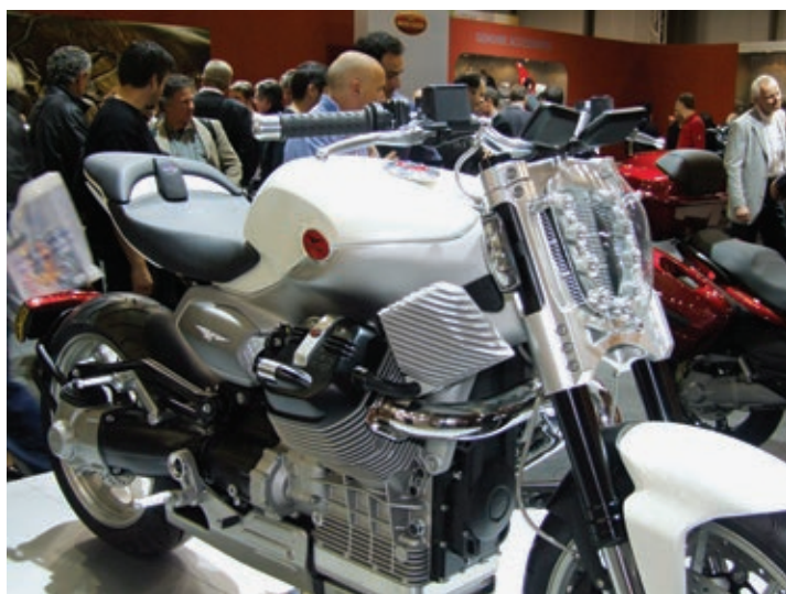
Hinter einem Plastikschild befinden sich neun LED-Lampen und ein Ölkühler.
