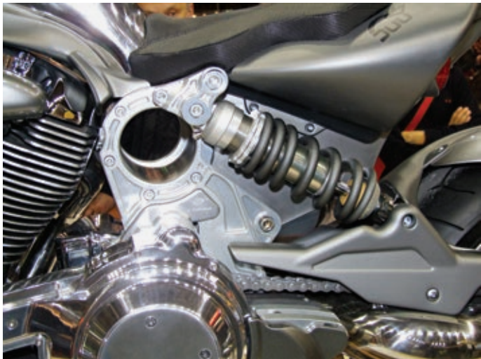
Frästeile, wie die Rahmenplatten, werden von Rizoma gefertigt.
