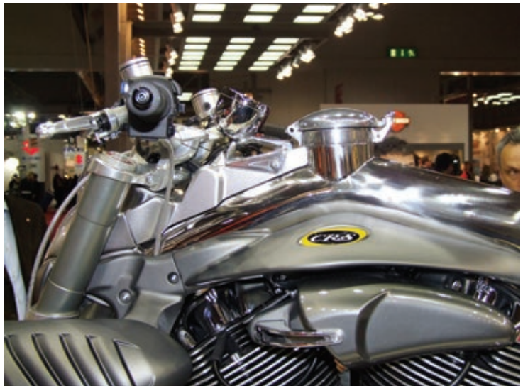
Ein armdickes, gewölbtes Edelstahlrohr ist Hauptrahmen und Tank zugleich.
