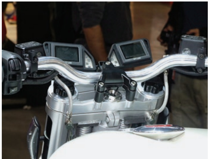
Zwei Displays ersetzen Cockpit und Rückspiegel. Die Hydraulikleitungen sind mit der Gabelbrücke verbunden.
