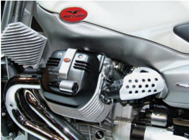
Rückstichtkamera auf der Außenkante des Ventildeckels, für die Serienfertigung vermutlich zu aufwendig und zu teuer.
