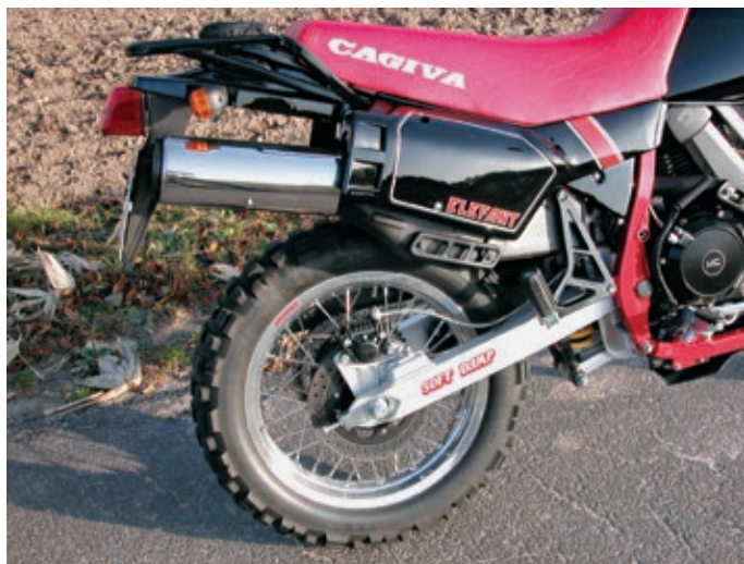
„Soft Damp“ nannte Cagiva die Zentralfederung mit Umlenkhebeln und Öhlins-Federbein.
