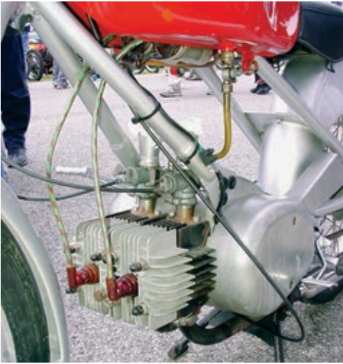
Die zwei Fallstromvergaser sorgten für mehr Leistung. Gut zu sehen ist das Schutzblechteil, welches zwischen den Rahmenrohren eingeschweißt ist.
