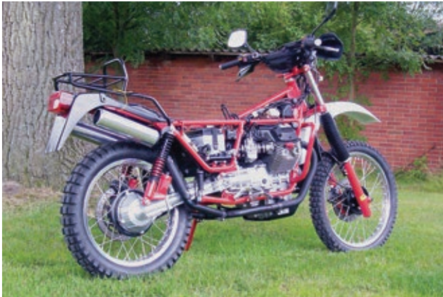
Auf Basis der V 65 schuf Moto Guzzi die V 65 TT (tutto terreno). Bei der Auspuffanlage mit zwei Schall-dämpfern handelt es sich um Zubehör.
