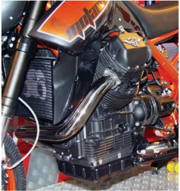
Der Wasserkühler vor dem Motor fällt kaum auf, und die Zylinder verfügen über schöne Kühlrippen.
