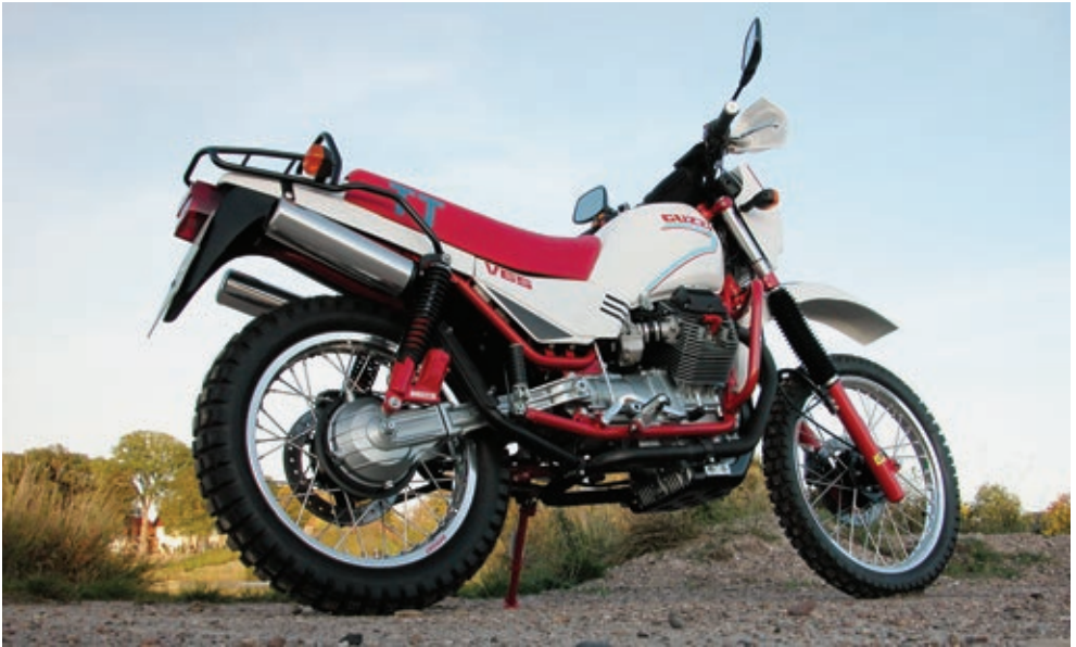
Genauso wie die BMW R 80 G/S verfügt die Moto Guzzi V 65 TT über einen Kardanantrieb. Der Gepäckträger schützt die hinteren Blinker.
