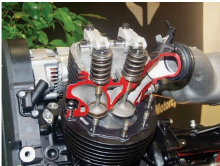
Zwei große Titanventile stehen fast parallel zueinander. Rollen an den ventilseitigen Enden der Aluminium-Kipphebel sollen den Verschleiß reduzieren.
