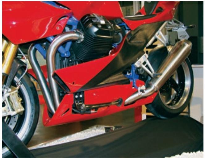
Lange Luftkanäle mit Öffnungen neben den Krümmern leiten kühlenden Fahrtwind am Motor vorbei zu dem unter der Sitzbank positionierten Ölkühler.
