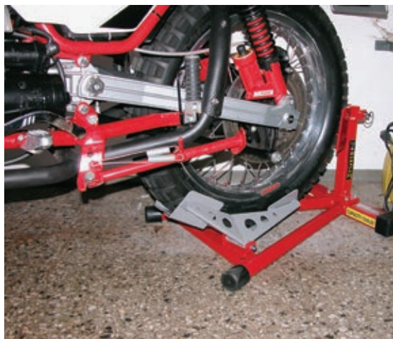
Für die V 65 TT produzierte Moto Guzzi eine längere Version der im Getriebe gelagerten Aluminiumschwinge.
