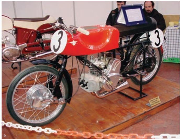
Die SS 52 Gobbetto war eine reine Rennmaschine. Bei diesem Modell verwendete Rumi erstmals eine Schwingengabel. Diese Maschine aus der zweiten Serie mit Hinterradschwinge wurde als Piantoni-Replica aufgebaut.
