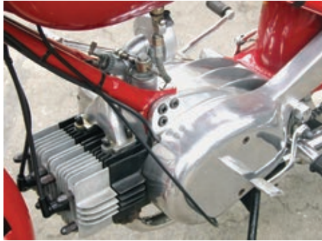
Die Zylinder der Turismo haben nur vier seitliche Kühlrippen. Der Vergaser ist schräg auf einen Y-Ansaugstutzen montiert.
