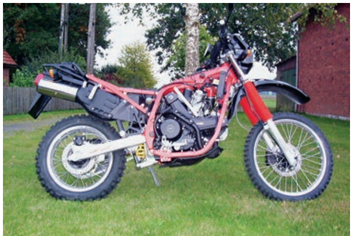
Cagiva entwickelte für den Elefant ein komplett neues Fahrwerk mit Rechteckrohrrahmen und Zentralfederbein.
