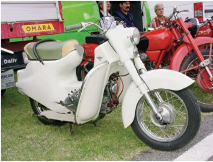
Große Räder und eine Telegabel verleihen dem Roller Scoiattolo motorradähnliche Fahreigenschaften. Der Vergaser zeigt in Fahrtrichtung.
