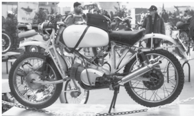
Für den Geländesport entwickelte Rumi die Regularita Sei Giorni mit geschobener Langschwinge ngabel und Versteifungsstreben im Rahmen.
