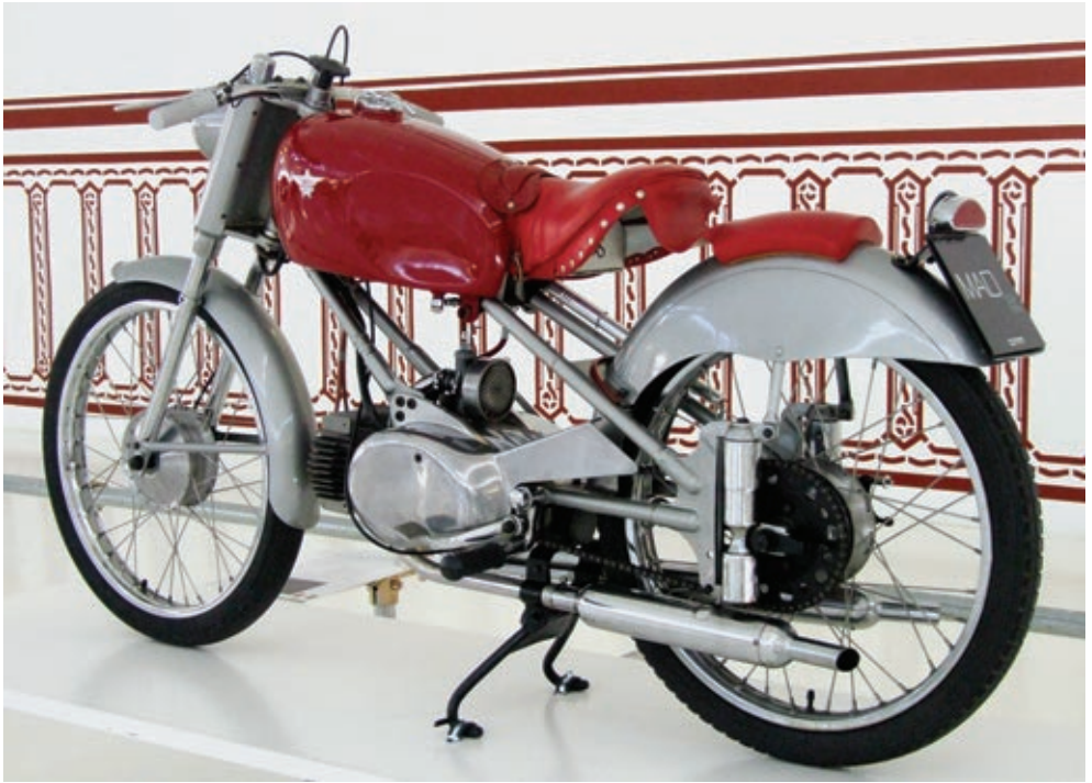
Eine Rumi 125 Sport mit waagrechtem Vergaser. Das Polster auf dem Hinterradschutzblech ist für den Fahrer gedacht, damit er sich auf langen Geraden möglichst flach auf der Maschine zusammenfalten kann.
