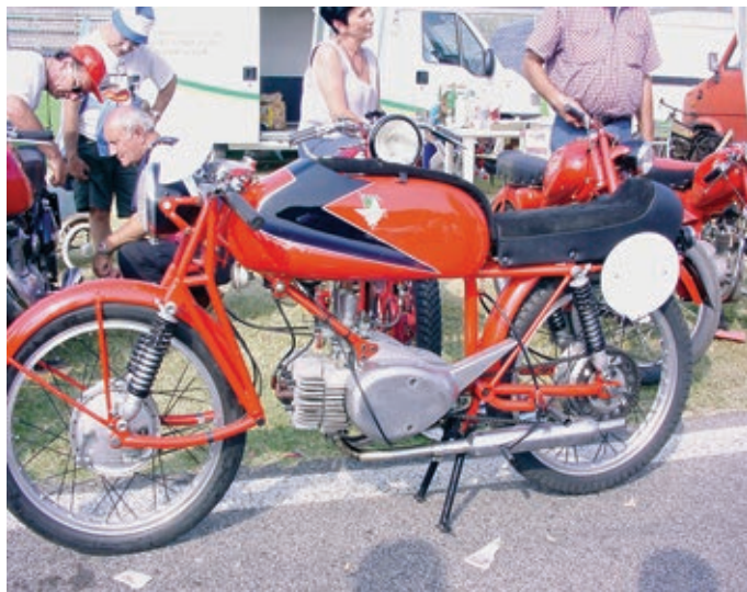
Anfangs verwendete Rumi in der Junior eine Gabel, die ähnlich wie bei der Regularita Sei Giorni war, aber die unteren Stoßdämpferhalterungen befanden sich weiter vorne bei der Radachse.
