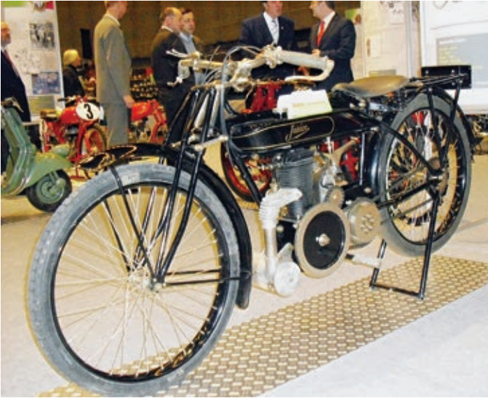
85 Jahre alt ist diese Junior 350. Vorderradbremsen gab es damals noch nicht. Der Auspuff besteht aus mehreren Teilen.
