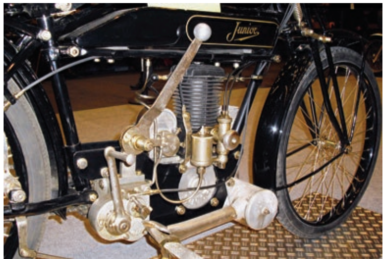
Viele Bauteile an der Junior sind aus Messing gefertigt.
