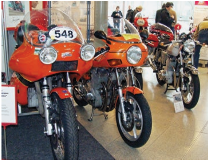
Links eine Langstreckenrennmaschine von Laverda mit breiter Verkleidung. Daneben eine Jota und eine ältere 1.000er mit dem Dreizylindermotor.
