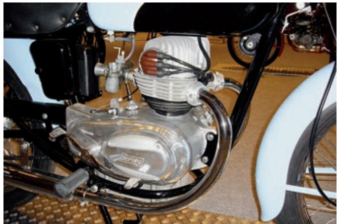
Der Verteiler für den Zündfunken sitzt im stark verrippten Ventildeckel und wird von der Nockenwelle angetrieben.
