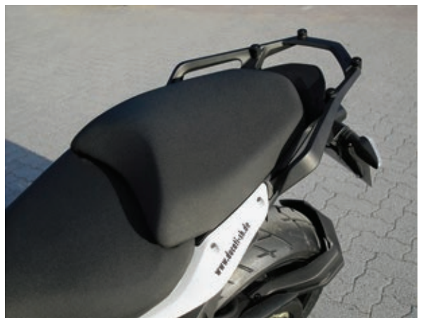
Viel Platz für die Sozia. Im Heckteil mit den Haltegriffen sind bereits Gewinde für einen Gepäckträger vorhanden.
