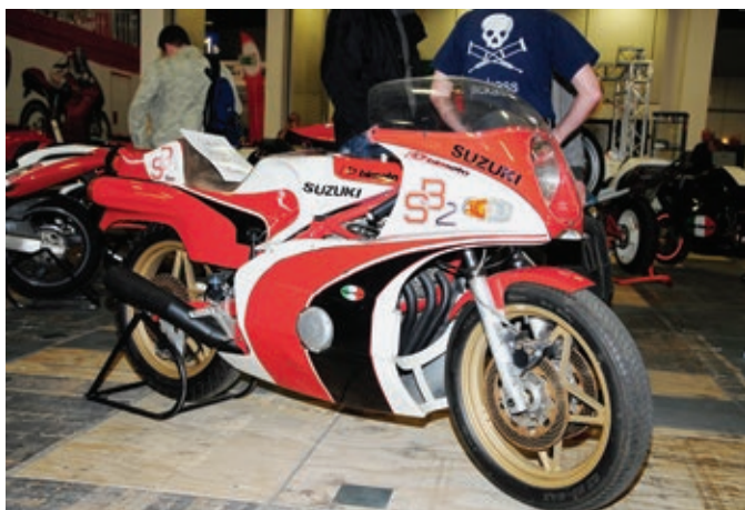
Die SB2 mit teilbarem Rahmen und koaxialer Schwingenlagerung war einer der Meilensteine in der Geschichte von Bimota.
