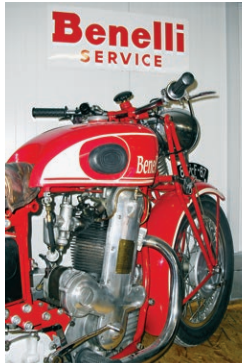
Benelli TN 500 von 1936 mit obenliegender Nockenwelle und Zahnradkaskade.
