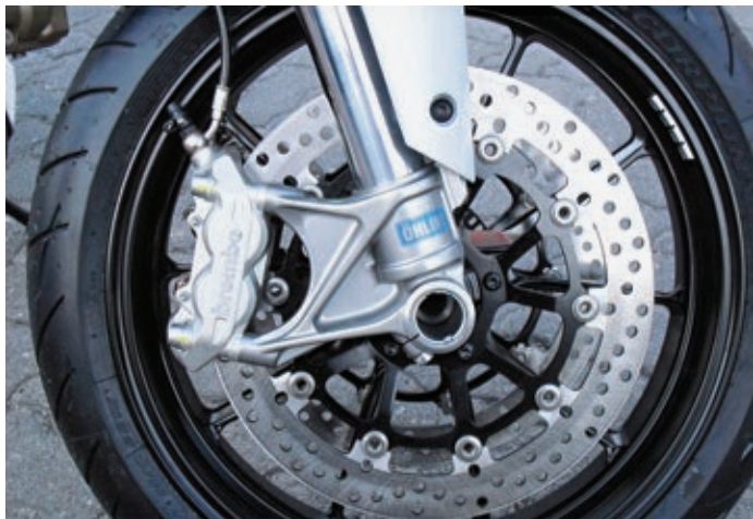
Öhlins-Gabel mit den etwas gemäßigeren Vierkolben-Bremssätteln, die nicht so giftig ansprechen.
