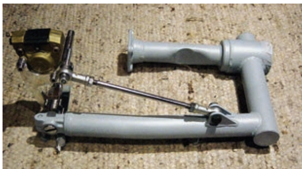
Die Schwinge wurde für den Breitreifenumbau und die Bremsmomentabstützung umgeschweißt.
