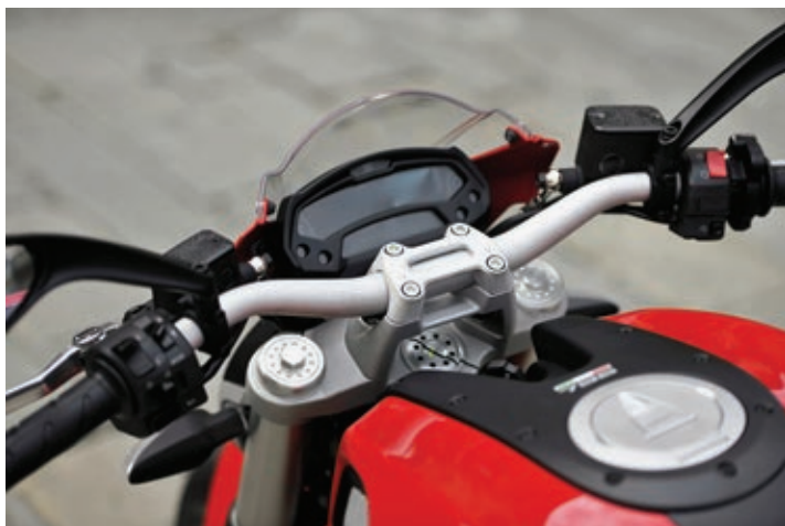
Ein höherer Halter verlegt den Lenker um 20 Millimeter nach oben. Die Gabel ist nicht einstellbar, und die Handpumpen stammen ebenfalls von dem kleinen Monster.
