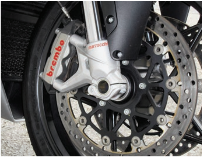
Italienische Hardware - Marzocchi-Gabel mit Schnellverschlüssen und Brembo-Bremssätteln.
