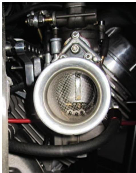
Zwischen Vergaser und Trichter versteckt sich ein kleines Gittersieb um größeren Dreck abzuhalten.
