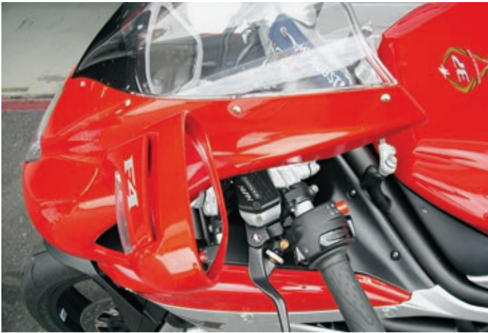
Auf den Rückspiegeln befinden sich kleine Spoiler, die den Wind über die Schultern ablenken sollen. Stufenlos verstellbar sind die Handhebel.
