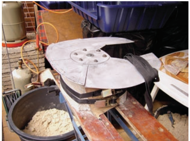
Das grob zurechtgeschnittene Verkehrsschild festgeschraubt auf dem Formklotz.
