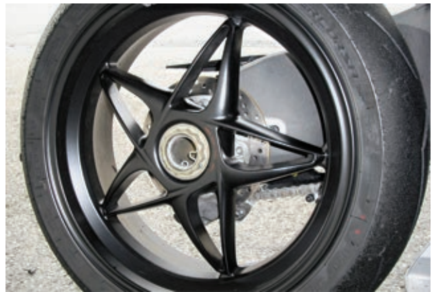
Die Speichen der Hinterradfelge sind asymmetrisch. Knickventile befinden sich in beiden Rädern, und der versteckte Bremssattel kommt genauso wie die Handpumpen von Nissin.
