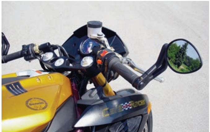
Die Stummellenker bringen mehr Gewicht auf das Vorder- rad. Die Sitzposition ist aber nicht extrem sportlich.
