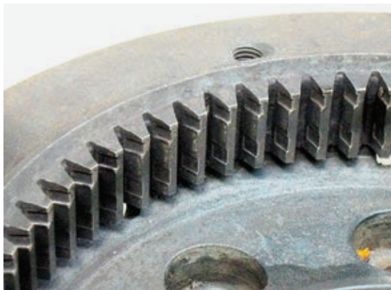
Eingeschlagene Verzahnung einer Schwungscheibe.
