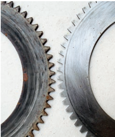
Zwei Zwischenscheiben. Bei der Linken sind die Zähne recht abgenutzt.
