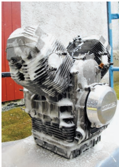
Schaumwäsche für den V2. Wenn das Motorrad schon mal zerlegt ist, lassen sich die Einzelteile besonders gut reinigen.
