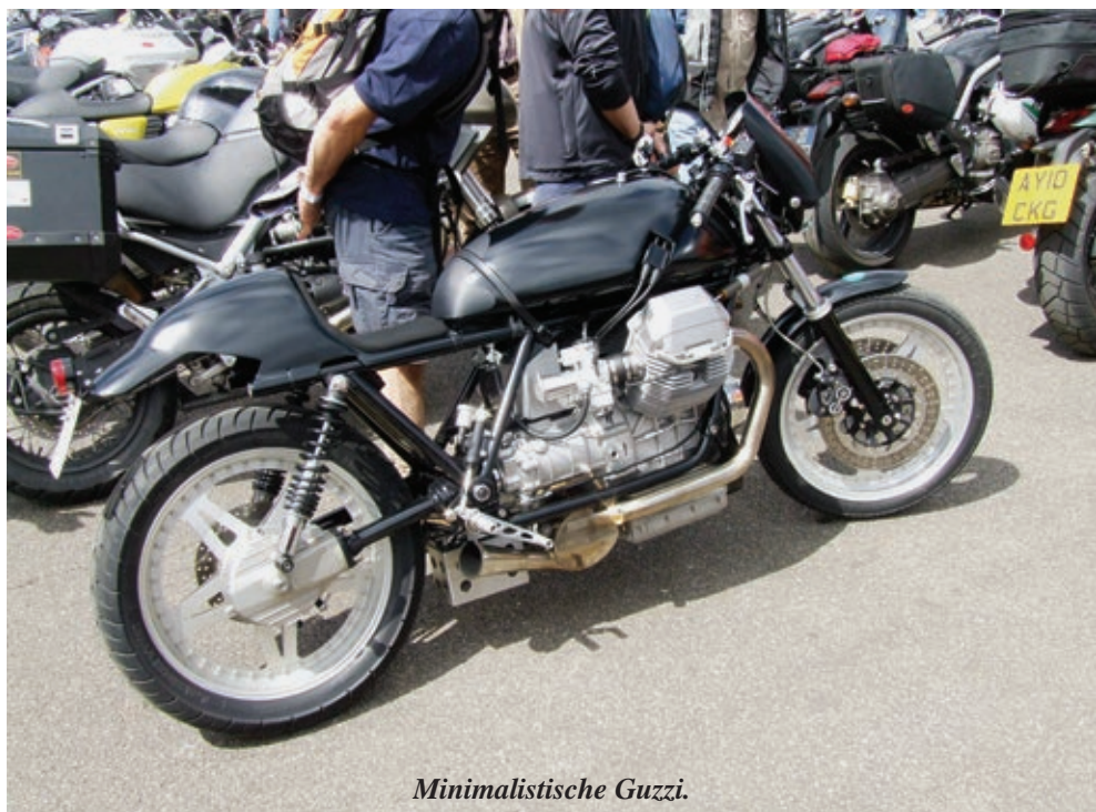
Extrem kurze Auspuffröte am Vorschalldämpfer. Der Bremshebel ist in verschiedenen Stellungen montierbar.
