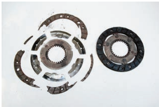
Die beiden Reibscheiben der Guzzi-Kupplung. Die linke ist in zahlreiche Einzelteile zerbrochen.
