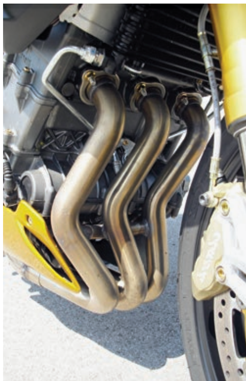
Die geschwungenen Krümmer schaffen Platz fürs Vorderrad. So kann der Motor weiter vorne im Rahmen montiert werden.
