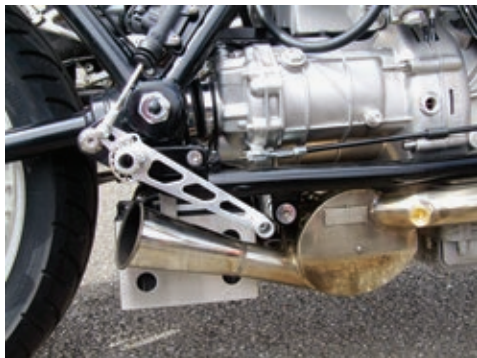
Extrem kurze Auspuffröte am Vorschalldämpfer. Der Bremshebel ist in verschiedenen Stellungen montierbar.
