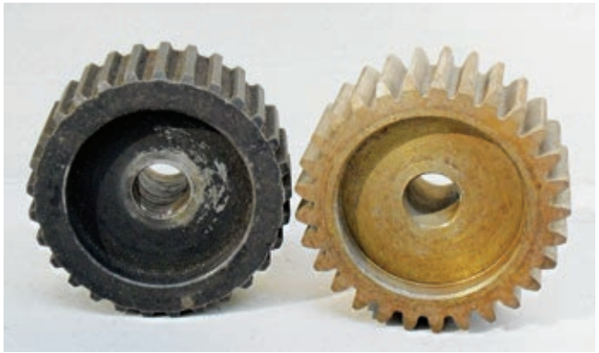
Bis 1989 verbaute Guzzi einen Getriebemitnehmer mit relativ kleinen Zähne. Seitdem gibt es eine bessere Version mit größeren Zahnflanken, die nicht so schnell verschleifen. An den Zentrierwerkzeugen ist der Unterschied gut zu sehen.
