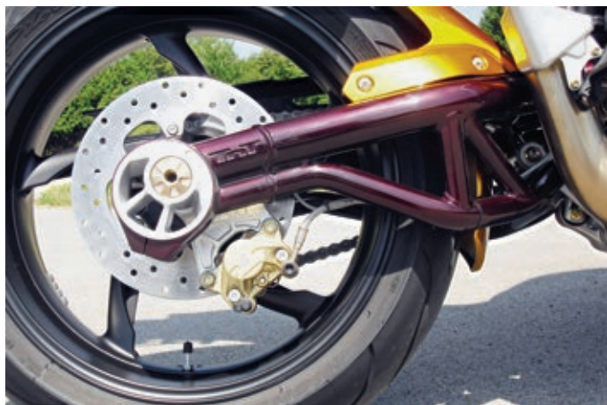
Ein echter Hingucker ist die Schwinge aus Stahlrohren mit unterschiedlichen Durchmessern und dem riesigen Exzenter, der das Kettespannen deutlich vereinfacht.
