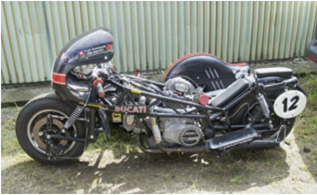
Ducati-Königswellengespann mit Gitterrohrrahmen.
