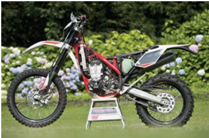
Ohne Anbauteile ist die Bauweise des Stahlrohrrahmens mit separatem Heckrahmen erkennbar.
