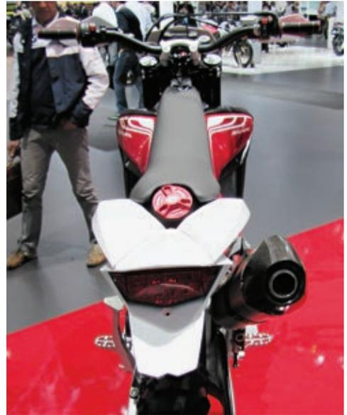
*Die Sitzbank reicht vom Lenkkopf bis zum Heck. Dort befindet sich der Tank-einfüllstutzen. Hier ein roter Aludeckel aus dem Zubehörprogramm.*
