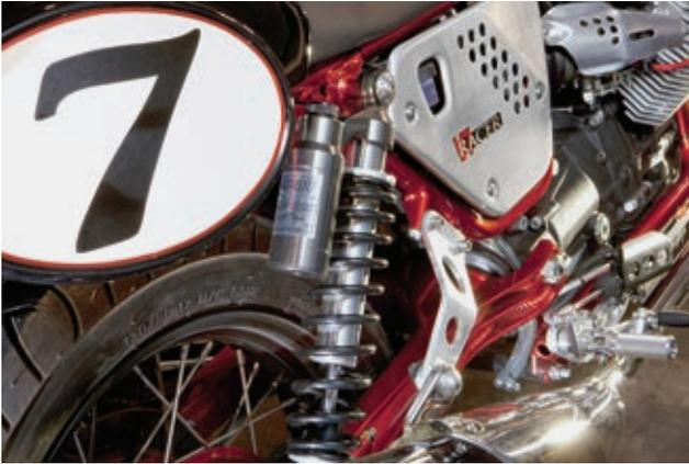
*Seitendeckel mit Sichtfenster für den Bremsflüssigkeitsbehälter, Auspuffhalter und die Fußrastenanlage sind aus gebürstetem Aluminium und verströmen das Renngefühl der sechziger Jahre.*
