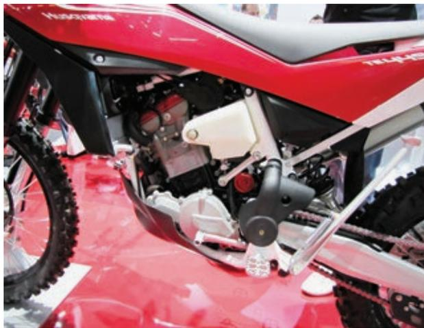
*Die Schwingenlagerung befindet sich in einer Flucht mit dem Ritzel auf der Getriebeausgangswelle. Dadurch bleibt die Kette immer gleich gespannt.*
