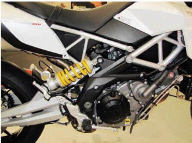
*Wie bereits die Dorsoduro 750 Factory verfügt auch die große 1.200er über einen Sachs-Stoßdämpfer mit Ausgleichsbehälter. Die Rahmenplatten aus Aluminium und der Kuppelungsdeckel sind nun schwarz lackiert.*
