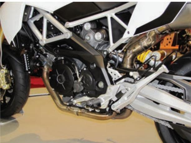
*Komplett neu ist die Auspuffanlage mit größeren Krümmern und den anderen Schalldämpfern. Der Heckrahmen wird nun aus Aluminiumstücken und nicht mehr aus Stahlrohren zusammenschweißt. Die Fußrasten erhielten Gummiauflagen zur Vibrationsdämpfung.*
