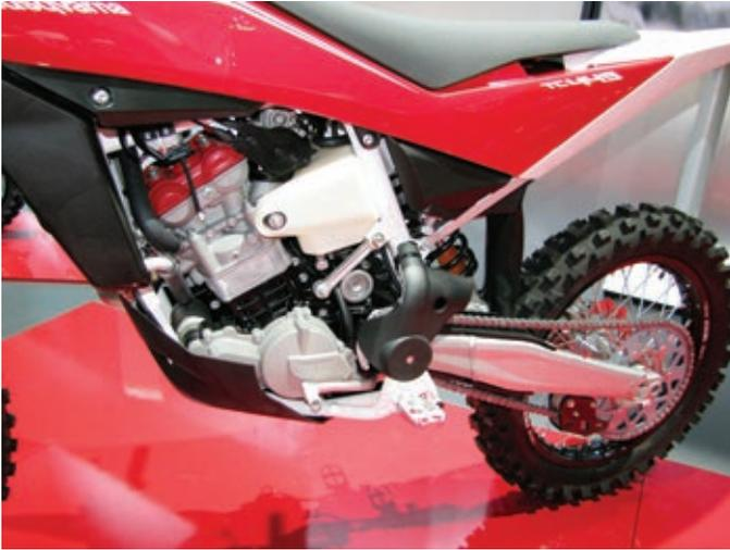
*Hinter dem Zylinder befindet sich der untere, transparente Tank. Enger kann man die Massen kaum noch konzentrieren.*
