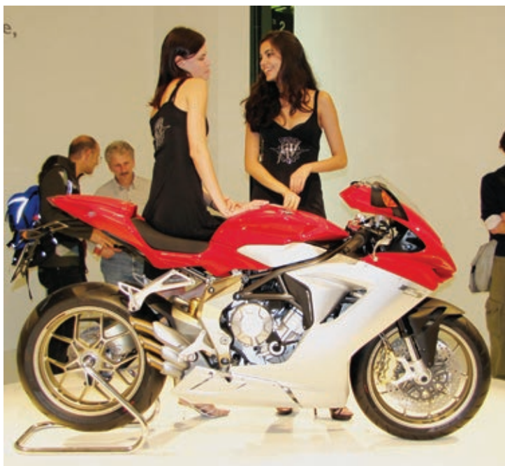
Ein Vorgeschmack auf die Saison 2012 zeigte MV Agusta mit einem Prototyp der F3. Im Vergleich zur F4 ist mehr vom Motor zu sehen. Die drei Rohre der Auspuffanlage weisen auf die Zylinderzahl hin.
