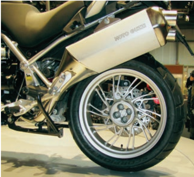
Neue Gußfelgen mit eigenwilligem Design. Auf dem schmaleren Hinterrad ist jetzt ein 150 Millimeter breiter Reifen statt des bisherigen 180er aufgezogen.
