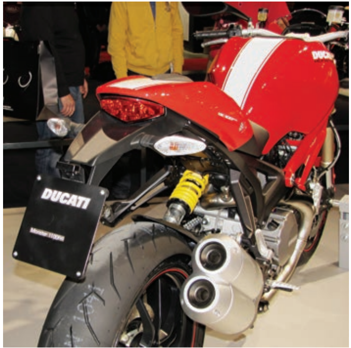
Leicht geändertes Heck mit gummigelagerten Blinkern und LED-Kennzeichenbeleuchtung.
