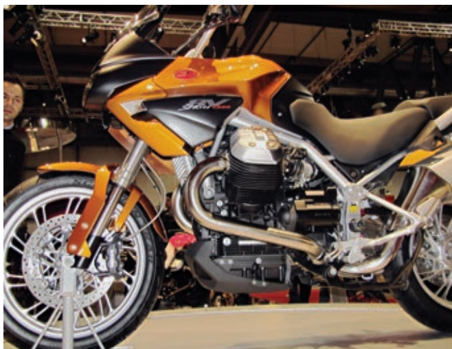
Das Tankvolumen wuchs auf stattliche 32 Liter. Ein Kühler vor dem Motor senkt die Öltemperatur.
