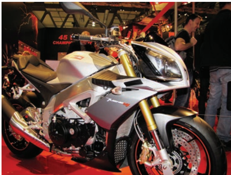
Die Aprilia V4R Tuono ist nur etwas knapper verkleidet als das Superbike. Den größten Unterschied machen der halbhohe Lenker und die daraus resultierende, aufrechte Sitzposition.
