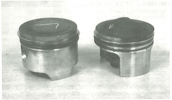
Rechts der Ø 92er Kolben. Um Gewicht zu sparen, ist er als Slipperkolben ausgeführt. Nach 30 000 km waren beide Kolben und Zylinder noch in neuwertigem Zustand. Links ein Kolben von einer V 1000 GS zum Vergleich.
