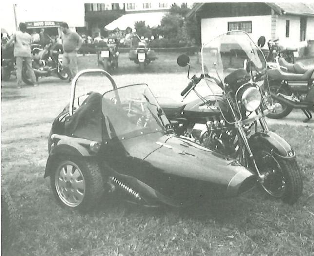
**Moto Guzzi California II mit Tremola-Seitenwagen. Hier mit einer höheren Scheibe ohne Seitenrahmen.**
