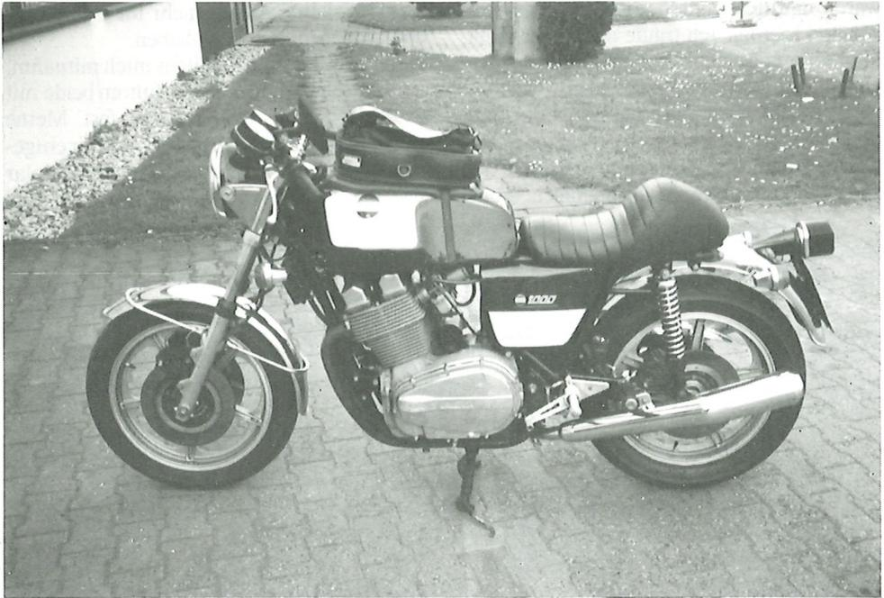
*In der zweiten Umbauphase wurde ein hinteres Schutzblech montiert und Tank und Seitendeckel erhielten weiße Felder.*
