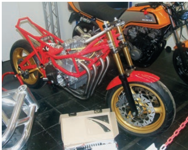
Eine Bimota KB1, die sich anscheinend gerade im Neuaufbau befindet. Von 1978 bis 1982 wurden insgesamt 827 Exemplare dieses Modells mit dem Motor der Kawasaki Z 1000 gebaut. Für die Restauration werden teilweise moderne Komponenten verwendet.
