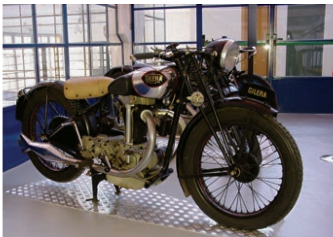
Eine Gilera VT 500 von 1933 mit Trapezgabel, Fußschaltung und Starrahmen.
