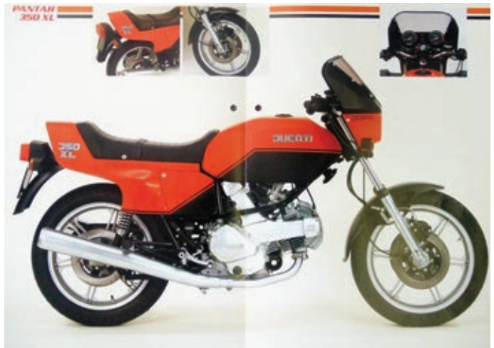
Die Pantah XL 350 bot einen höheren Lenker sowie eine kleine Cockpitverkleidung.
