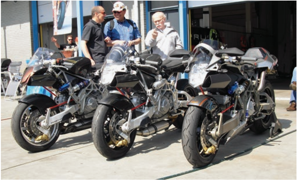
Vyrus-Motorräder mit Radnabenlenkung mit Zwei- und Vierventilmotoren von Ducati.
