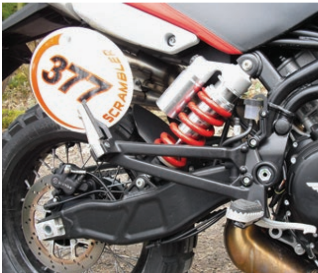
In einem neuartigen Verfahren wird die Schwinge unter Wasserdruck geformt.
