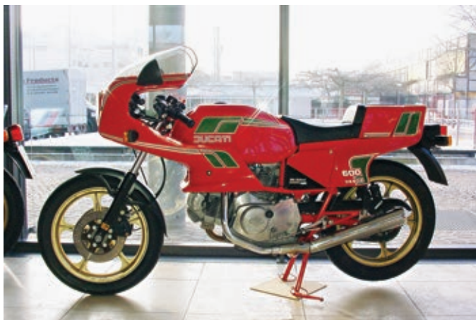
Pantah 600 im Design der Hailwood Replica. Die 600er hatte eine neue Verkleidung und größere Bremssättel vorne, die nun hinter der Gabel positioniert waren.
