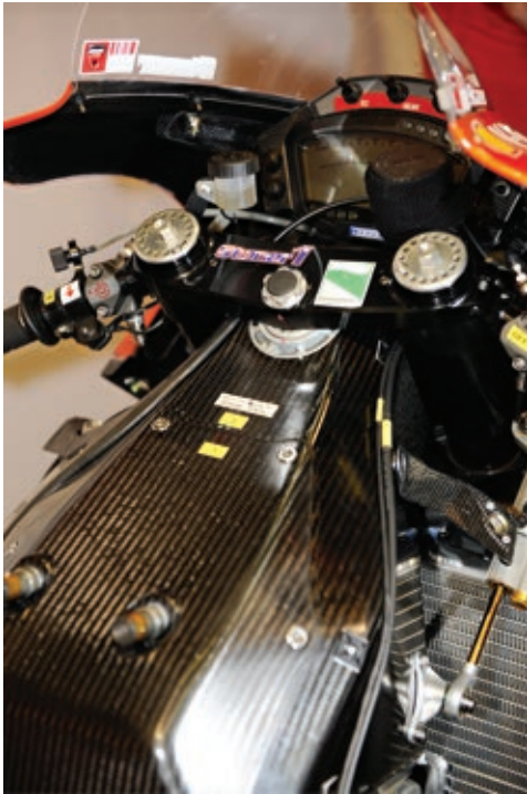
Die Airbox mit abnehmbarem Deckel übernimmt nun die Funktion des Hauptrahmens.
