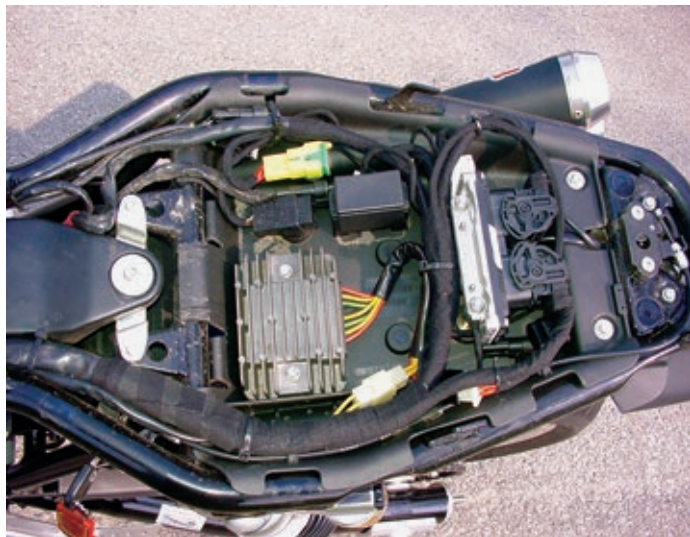
So sieht es serienmäßig unter der Ducati-Sitzbank aus. Der Regler sitzt tief in einer Plastikwanne, der kühlende Fahrtwind kann ihn dort nicht erreichen.
