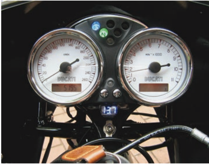
Unterhalb des Cockpits wurden eine kleine Volt-Anzeige sowie ein zusätzlicher Lichtschalter montiert.
