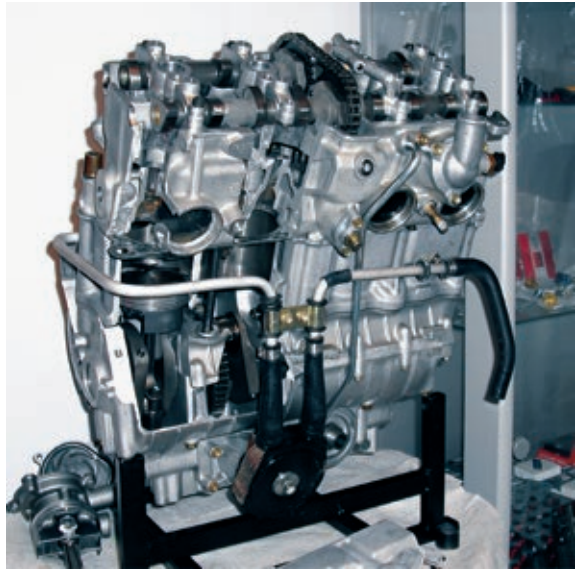
Aus einem Motorschaden hat Herr Schumacher diesen Schnittmotor geschaffen und somit den Einblick in die moderne Vierzylindertechnik.
