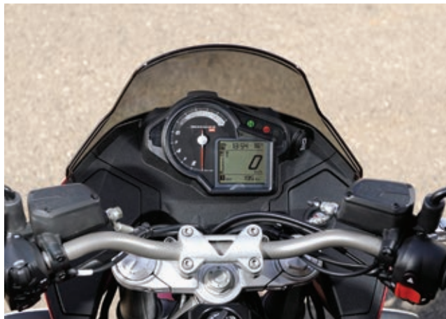
Rechts neben dem Cockpit befindet sich die Bordsteckdose. Die Ausgleichsbehälter für Handbremse und Kupplung haben die gleiche Größe.
