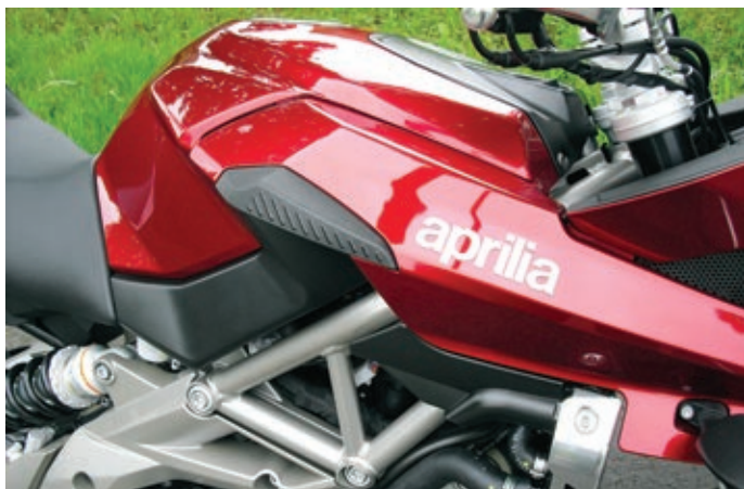
Die hintere Außenkante der Verkleidung ist als Sturzpad ausgeführt, damit bei einem Umfaller kein großer Schaden entsteht.
