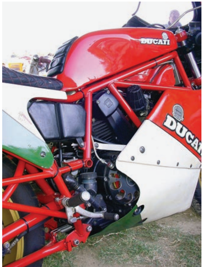
In der F1 werkelt der auf 750 Kubikzentimeter vergrößerte V2-Motor aus der Ducati Pantah.
