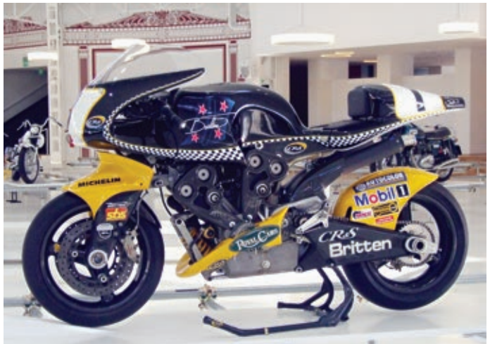
Frei von jeglichen Vorgaben schuf John Britten ein Rennmotorrad nach seinen eigenen Ideen. Die Vorderadgabel und die Carbonschwinge sowie das Federbein waren ohne Rahmen mit dem Motor verschraubt.
