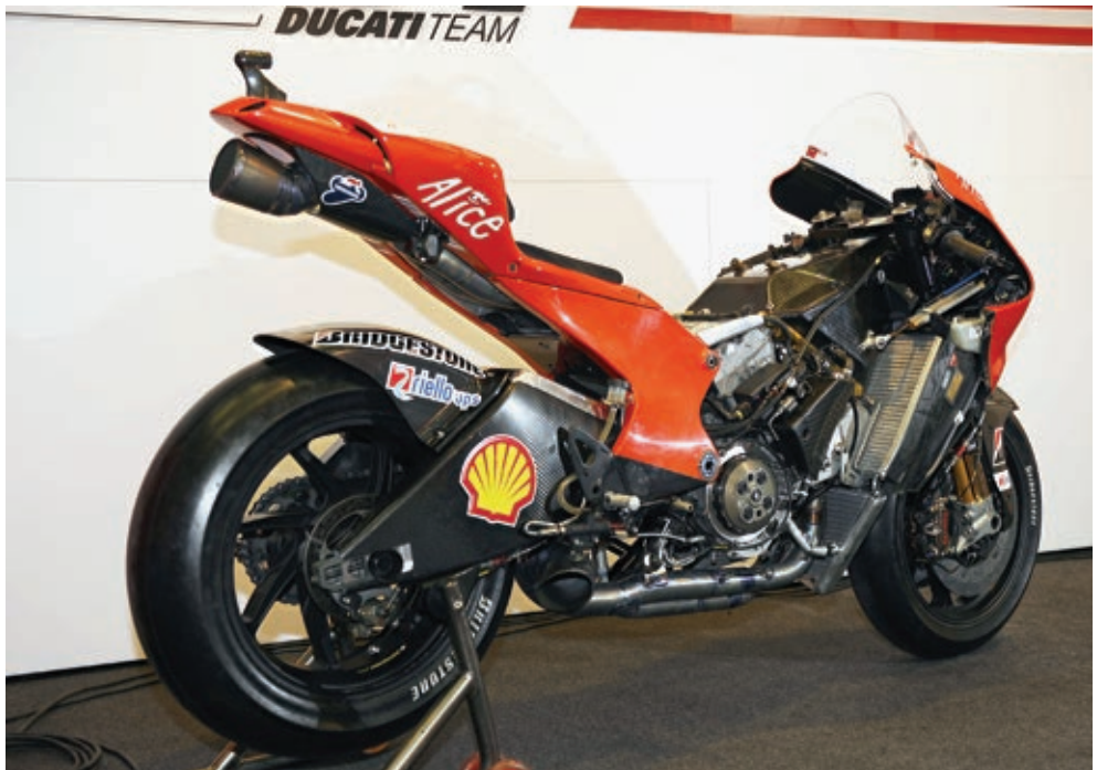
Die Ducati Desmosedici GP9 verfügt über eine tragende Airbox aus Carbon mit integriertem Lenkkopf und eine Carbonschwinge.
