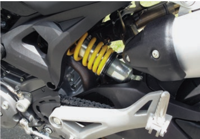
Die Auspuffanlage heizt dem Federbein ordentlich ein. Erstmals verzichtet Ducati bei der Monster auf ein Hebelsystem an der Hinterradfederung.
