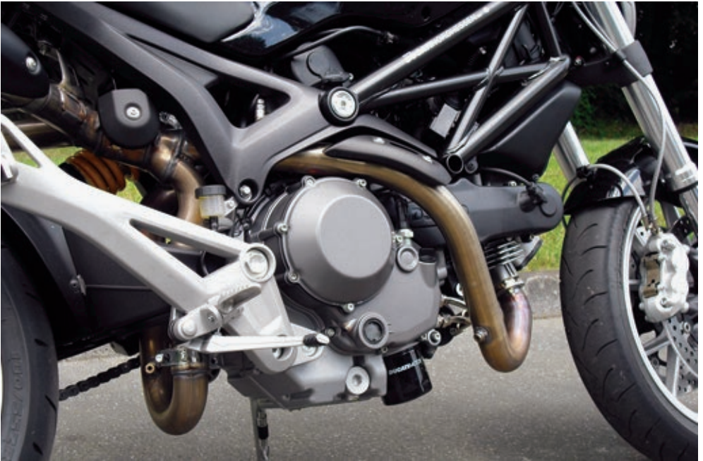
Der Krümmer des vorderen Zylinders verläuft oberhalb der Trockenkupplung und strahlt ordentlich Hitze ab. Von dem stehenden Zylinder ist nicht viel zu sehen.
