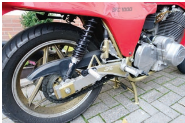
Schwinge und Fußrastenanlage sind aus Aluminium gefertigt.
