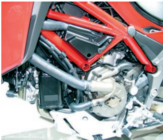
Bei der Ducati Multistrada 1200 befindet sich der Aktivkohlefilter links neben dem Zylinderkopf.
