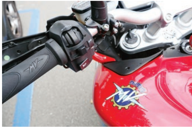
Der Mode-Schalter auf der linken Seite steuert das Cockpit.
