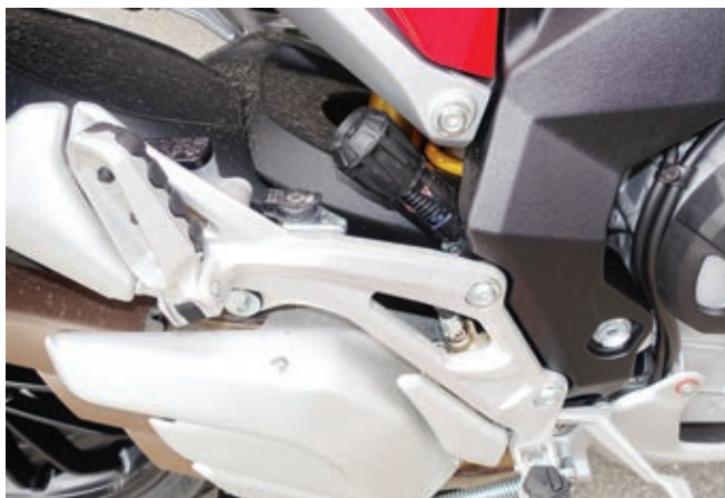
Die Federvorspannung hinten kann leicht mittels Handrad verstellt werden. Daneben befindet sich eine der Bordsteckdosen.
