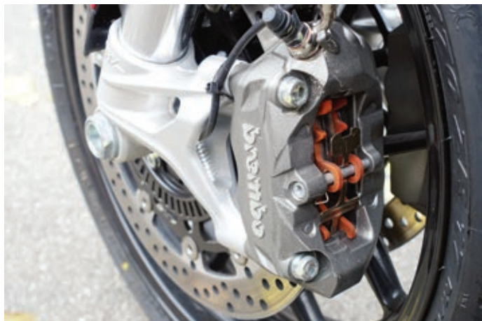
Radiale Monoblock-Bremssättel von Brembo sorgen zusammen mit dem ABS für standesgemäße und sichere Verzögerung. Die Gabelfüße sind CNC-behandelt.
